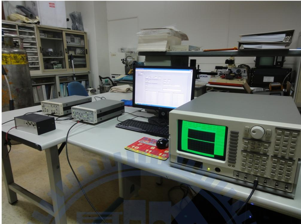
圖 3-28 重複取樣雜訊量測系統
