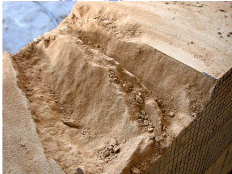
圖 14 No.20-2 於實驗完後沿裂縫破壞面撥開狀
