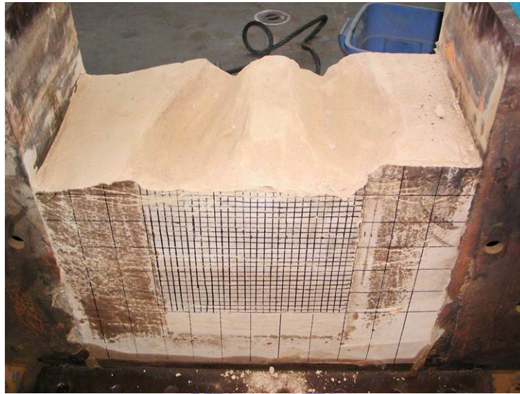
圖 9 No.10-2 裂縫剝開後的試體
