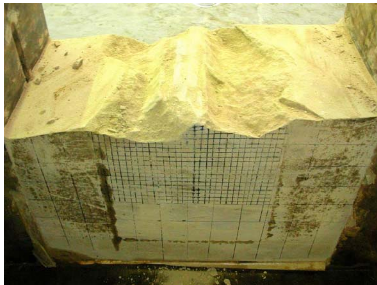
圖 10 No.10-3 度裂縫剝開後的試體
