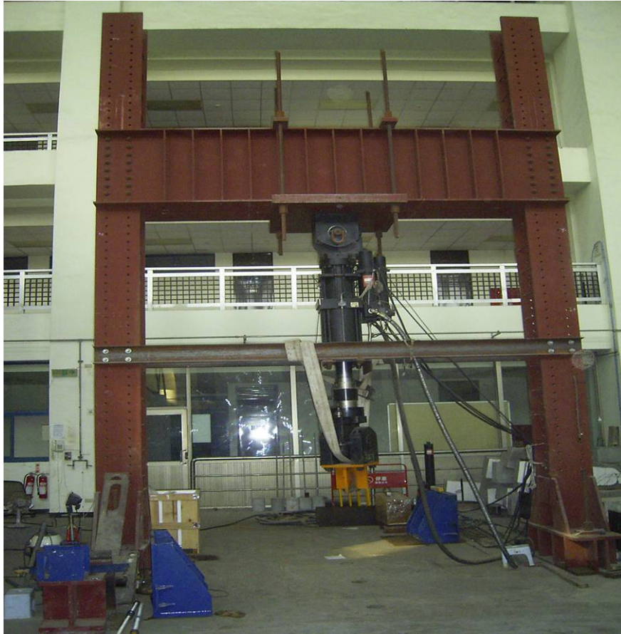
圖 3.7 土木結構試驗室之 MTS-244.41S
