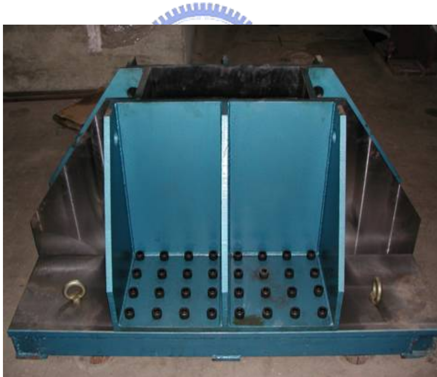
圖 3.5 試驗盒完整組立狀
