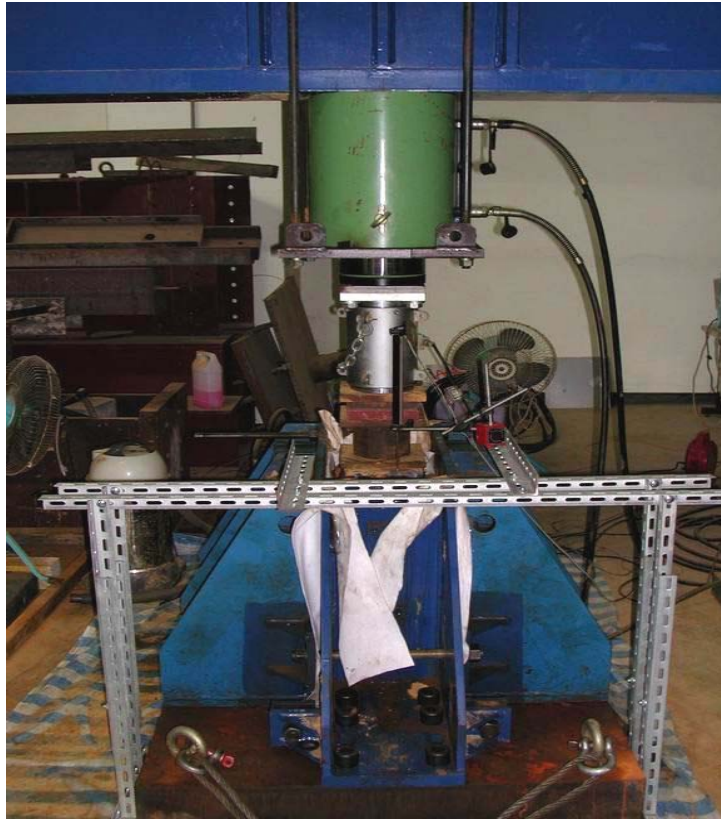
圖 3.11 人造膠結不良砂岩壓密情形
