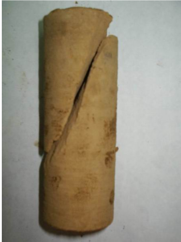
圖 4.9 本研究 No.10-2 乾躁三軸試驗試體破壞狀
