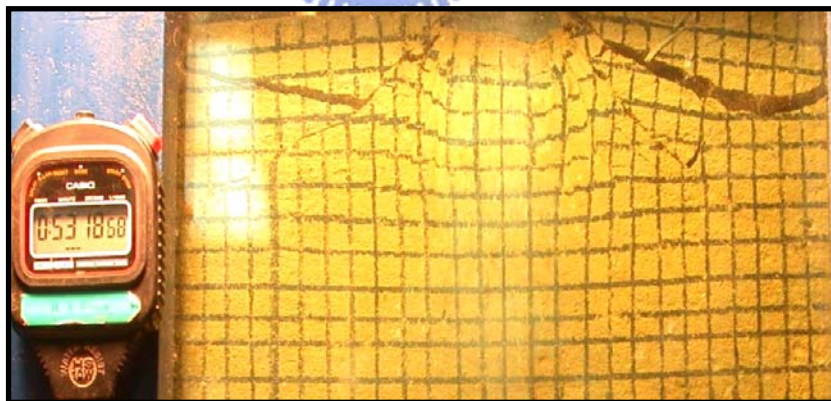
圖 4.32 No.0-1 於承載曲線破壞段
