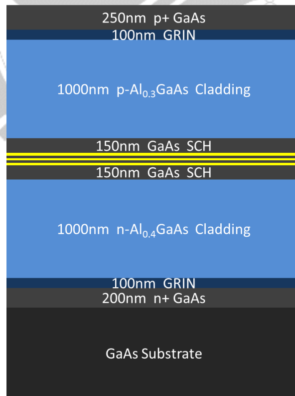
圖 5.1 Lm5172 三層量子井雷射磊晶結構
