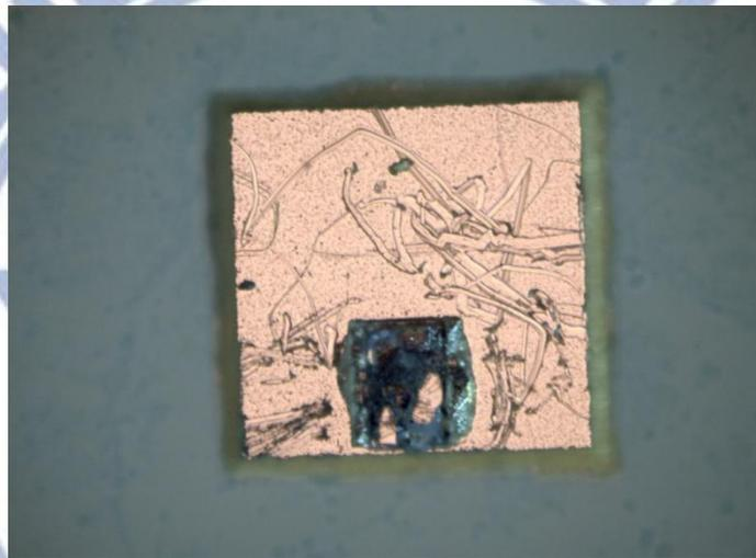
圖 4.9：Bonding Window 內元件推離表面圖
