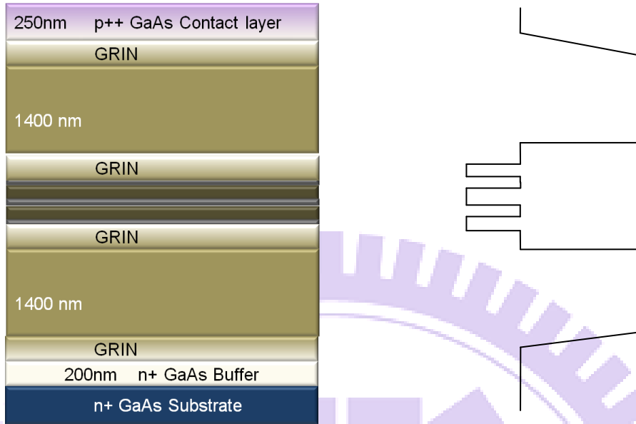
圖三.2 Lm5204 三層量子井雷射磊晶結構示意圖
