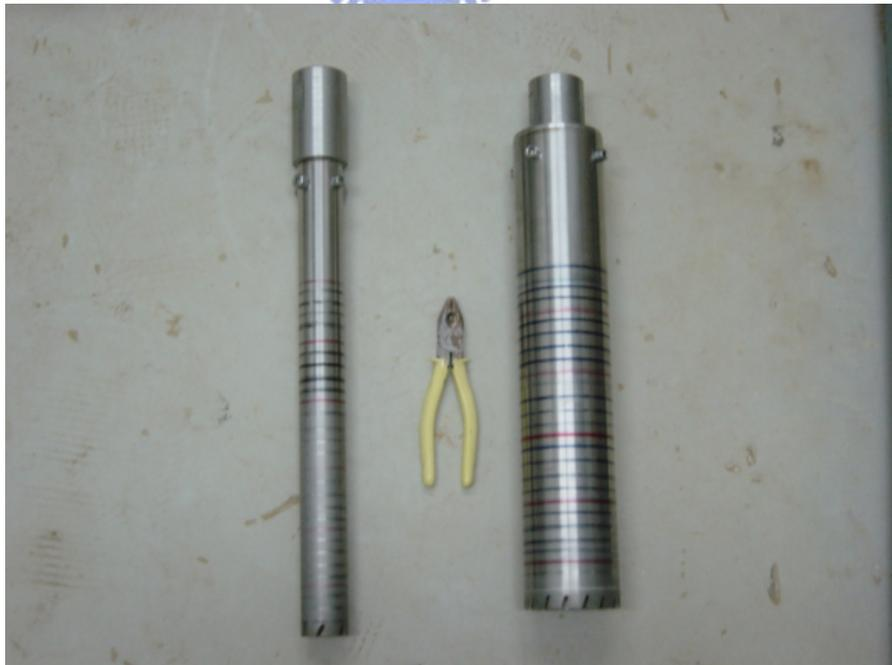
圖 3.23 特製的薄管型岩心筒
