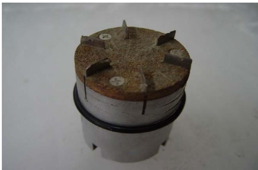
圖 3.9 原系統的試體上加載板及鱗片
