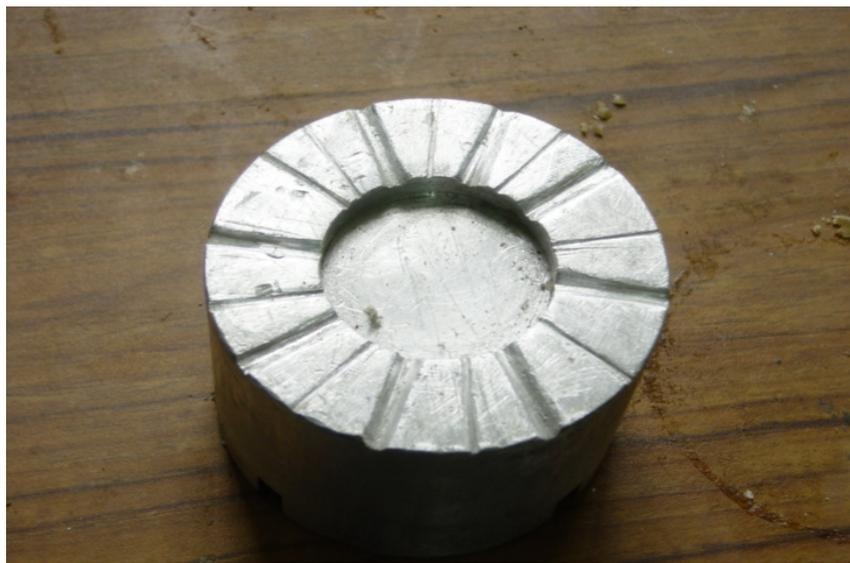
圖 3.11 本研究採用之上載板並刻溝槽，再以粘膠接著傳遞扭力
