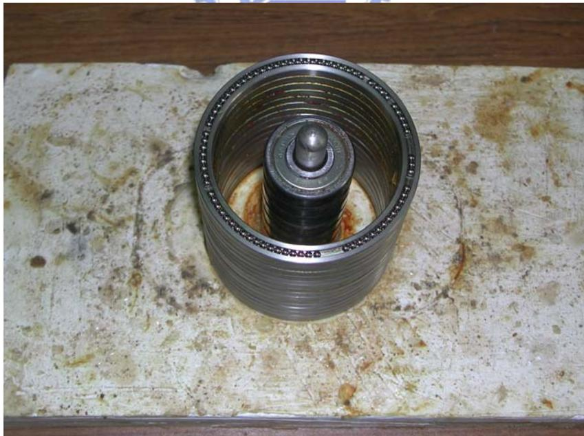
圖 3.13 試體橫向內、外束制環（完全組立）
