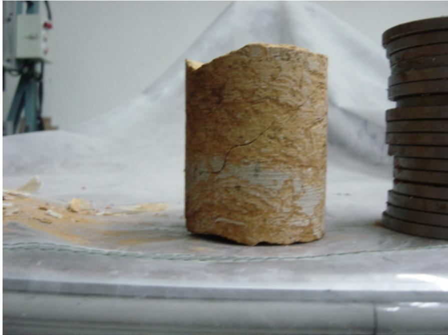
圖 3.27 改用黏膠方式，傳遞扭力且破壞面自由發展
