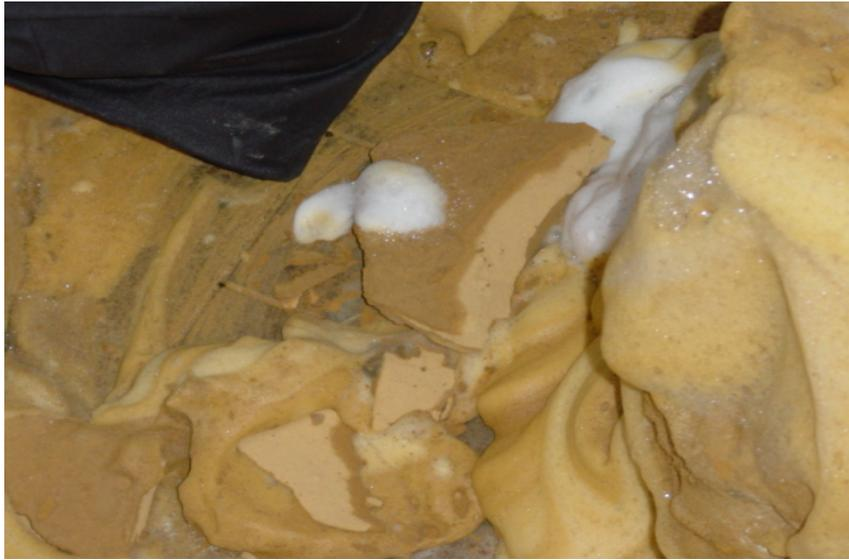
圖 3.21 嘗試以傳統泡沫介質鑽取中空軟岩試體
