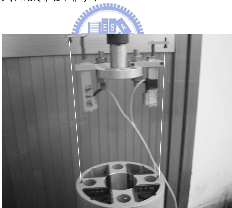
圖 3.14 改良後上部位移量測系統
