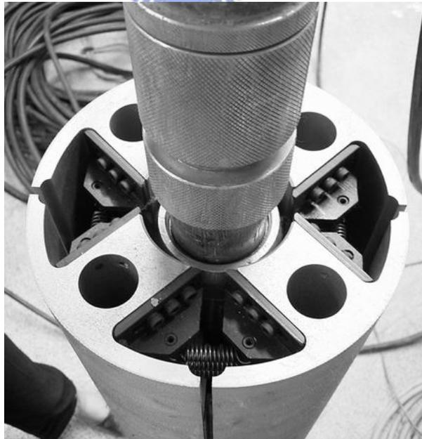
圖 4.5 系統阻抗標定時孔內千斤頂試驗裝置膨脹之俯視圖
