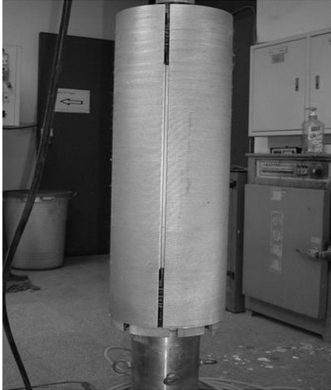
圖 4.4 系統阻抗標定時孔內千斤頂試驗裝置膨脹之側視圖
