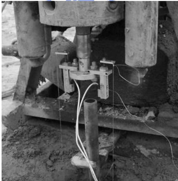
圖 5.6 上部位移量測系統
