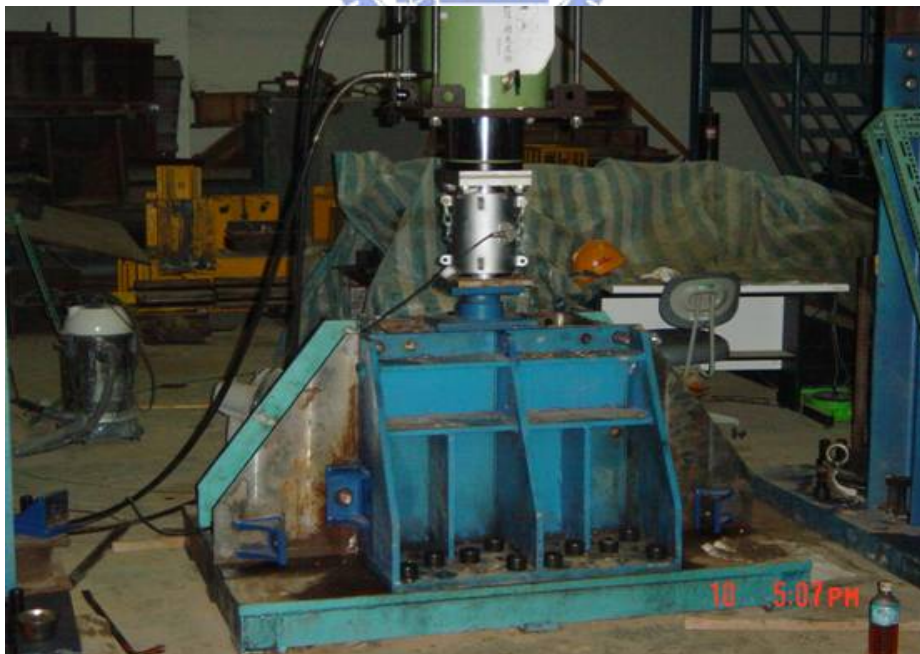
圖 3.11 人造膠結不良砂岩壓密情形
