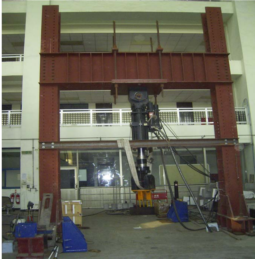
圖 3.7 土木結構試驗室之 MTS-244.41S
