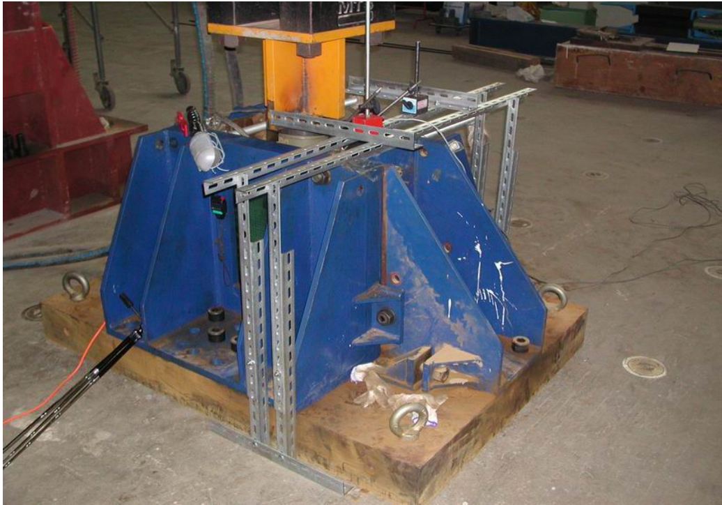
圖 3.15 LVDT 量測系統之整體照
