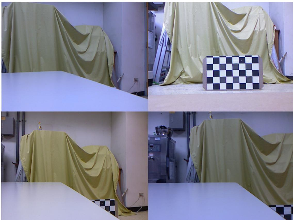
圖 34 Kinect 在相同光源下影像色彩差異示意圖
