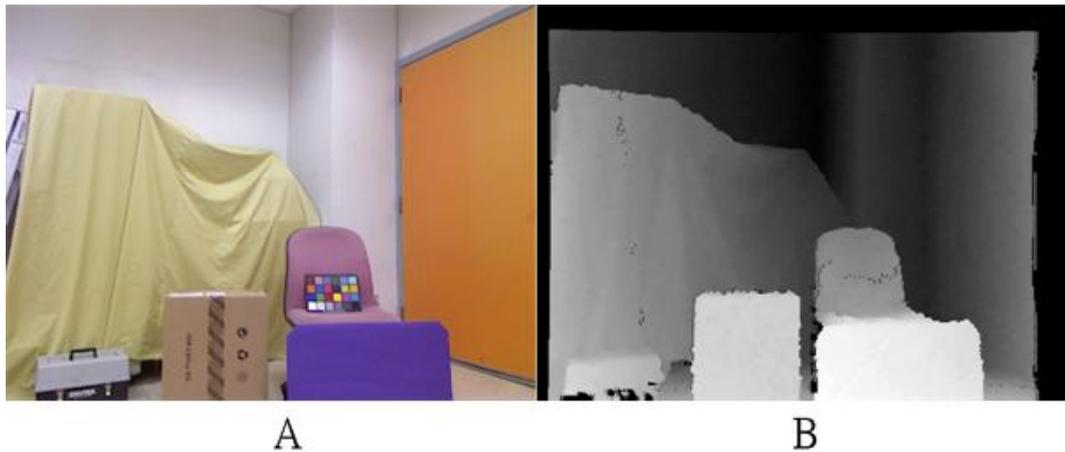
圖 112 A: 左邊 Kinect 輸出彩色影像 B: 左邊 Kinect 輸出景深影像
