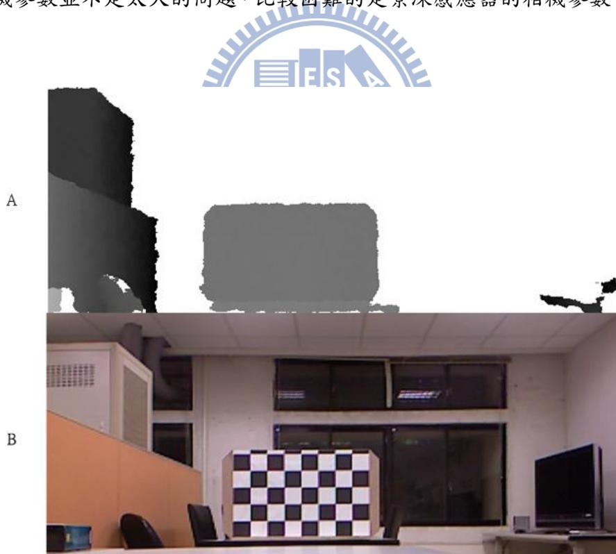
圖 38 A:校正版在景深影像 B:校正板在彩色影像
