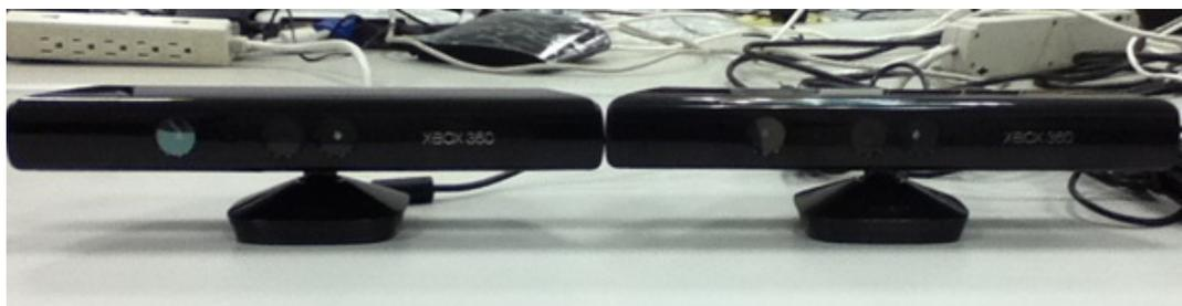
圖 31 兩台 Kinect 感應器擺放示意圖
