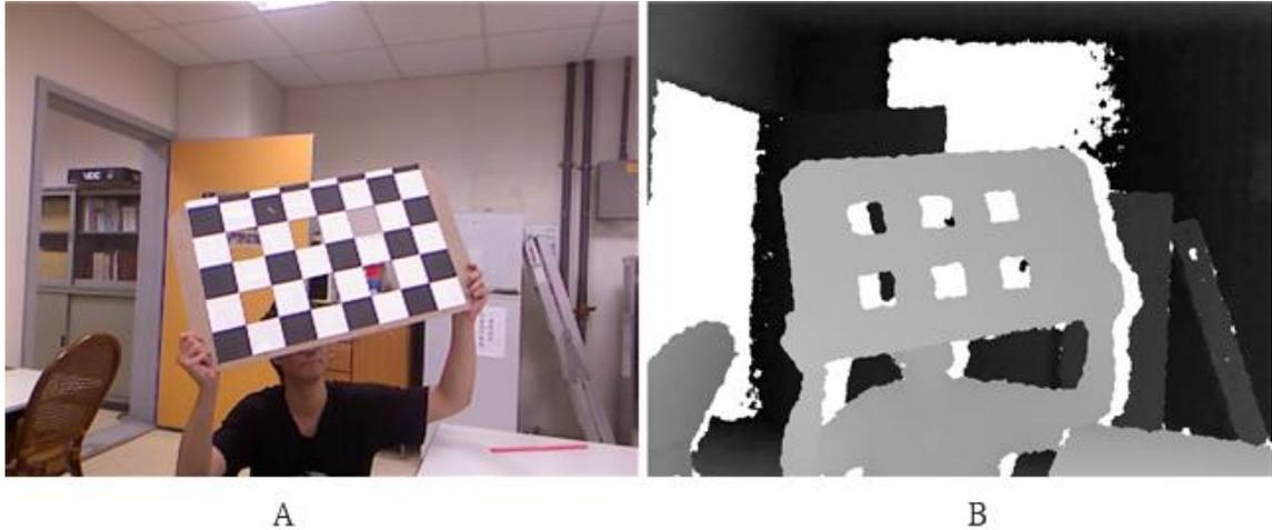
圖 39 A:挖洞校正版在彩色影像 B:挖洞校正版在景深影像
