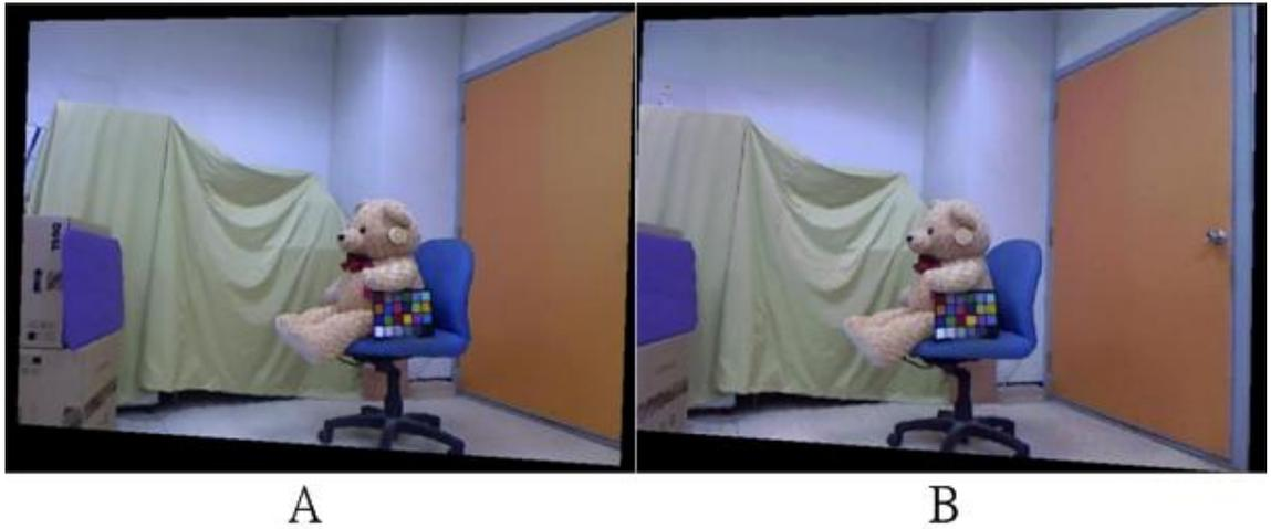
圖 170 A: 影像校正後左邊影像 B: 影像校正後右邊影像
