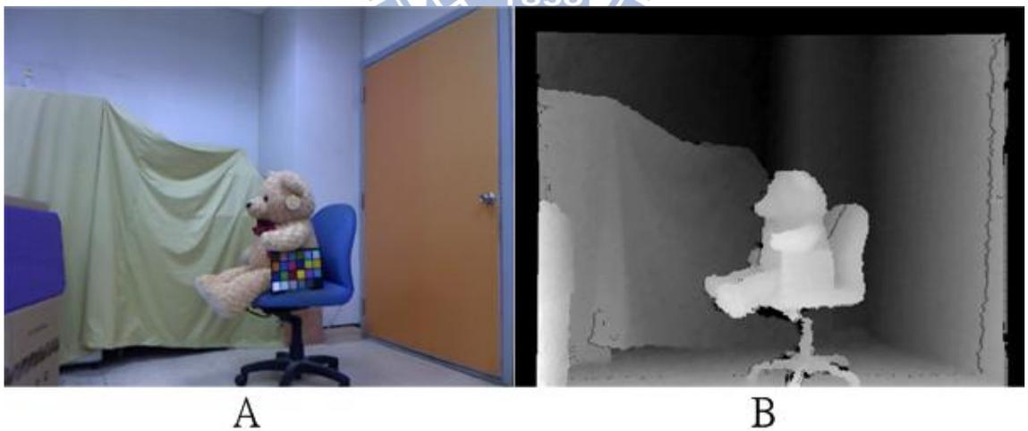
圖 168 A: 右邊 Kinect 輸出彩色影像 B: 右邊 Kinect 輸出景深影像
