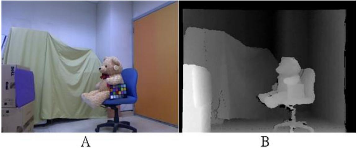
圖 167 A: 左邊 Kinect 輸出彩色影像 B: 左邊 Kinect 輸出景深影像
