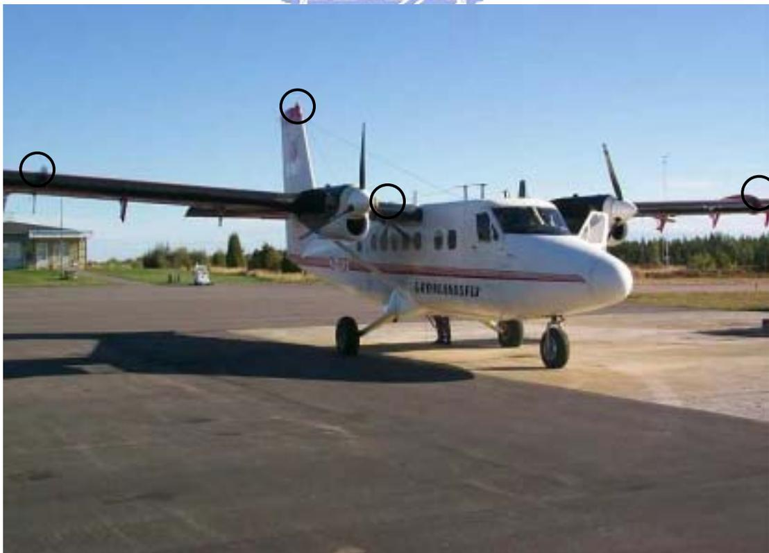
圖 3-7 空載重力測量飛機，DHC-6“雙水獺”
