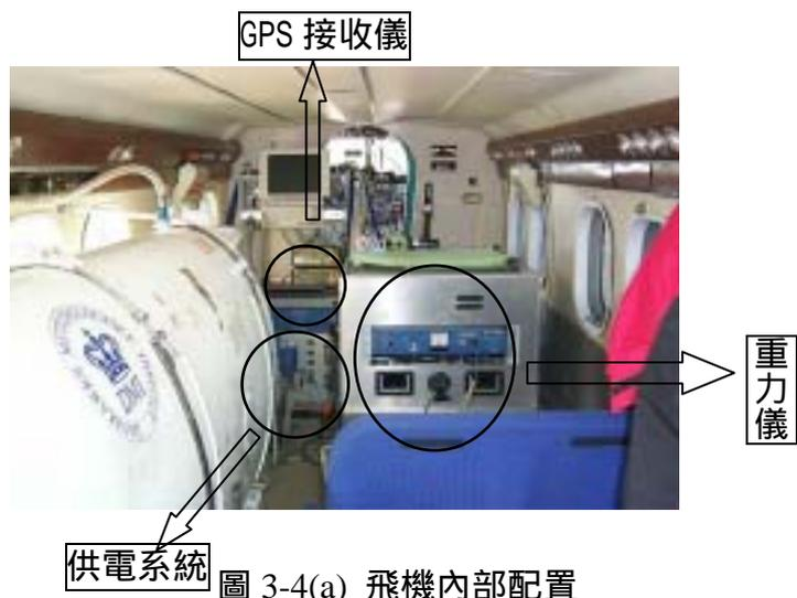
圖 3-4(a) 飛機內部配置
