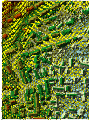
圖 4-5-6 原始 DSM 與濾除成果點雲分布圖
