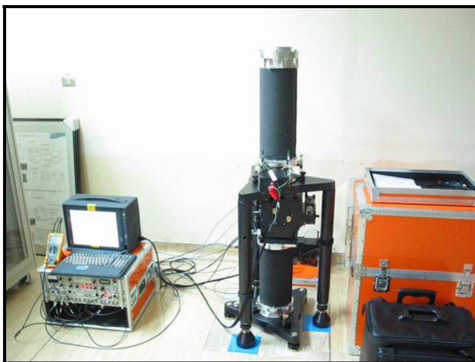
圖 2-3 目前內政部委託放置於國家工業研究院量測中心大地實驗室進行調校測試之絕對重力儀 FG5。圖中右側為儀器本體，主要有雷射干涉測距系統與自由落體機制；左側為其控制系統與處理觀測資料之電腦。
