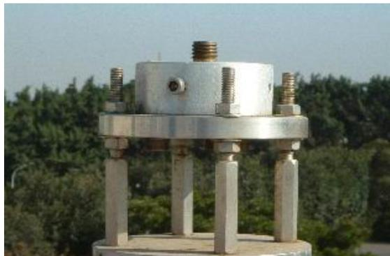
圖3-1 強制定心樁的定平機制
