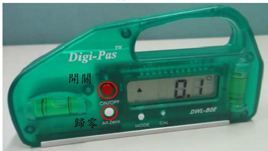
圖 4.1 電子氣泡式角度尺。
