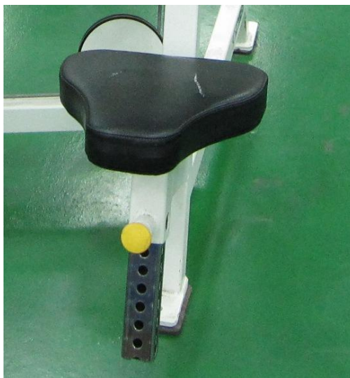
圖 3.17 肩推機椅座調整機構。
