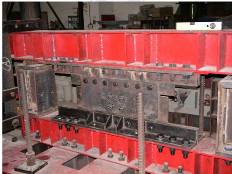
圖 5.20 摩擦制震壁測試構架組裝完成照片
