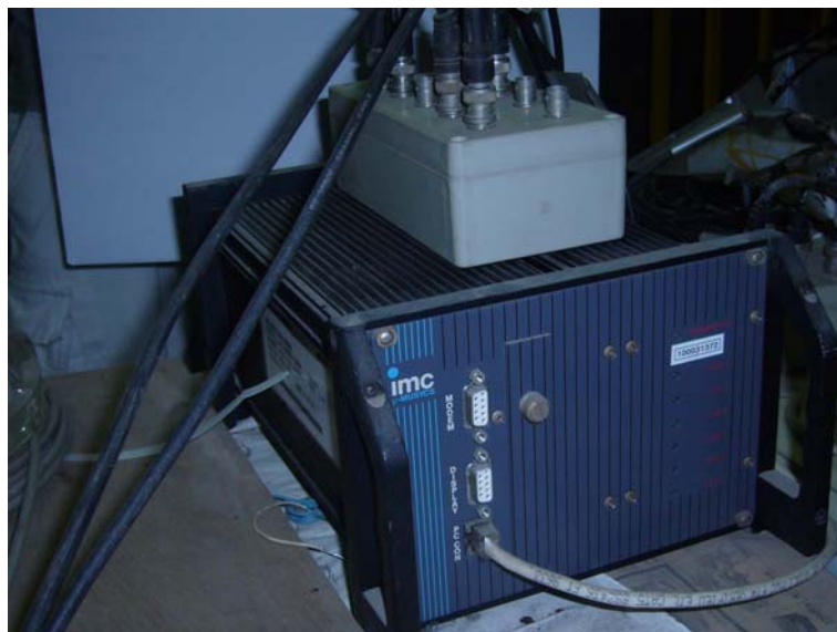
圖 4.5 IMC 資料擷取系統
