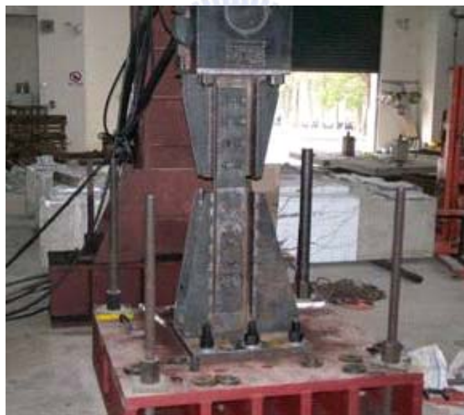
圖 5.10 摩擦阻尼斜撐測試構架組裝完成照片
