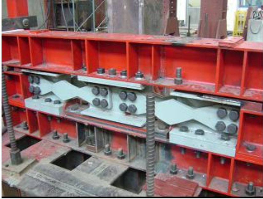
圖 3.45 對稱配置之足尺預彎拱鈹元件測試測試構架組裝完成照片
