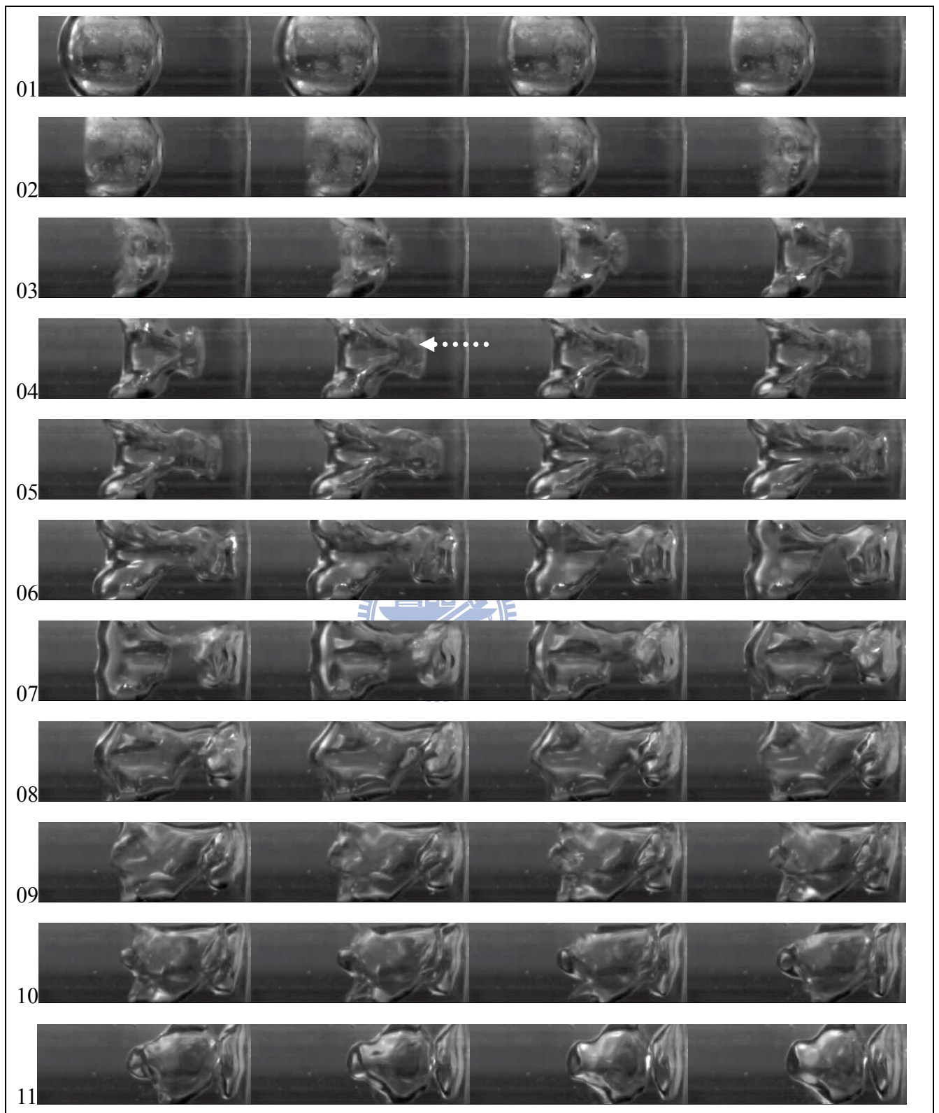
圖 4-18 震波壓力增強後距離參數 \gamma \approx 3 之穴蝕氣泡破裂過程影像；K-H 渦流為虛線箭頭指示；壓力波強度為 300kPa，影像時間間距為 1/4000 秒，影像大小為 9.6 mm×3.1 mm，氣泡最大半徑為 2.35 mm。
