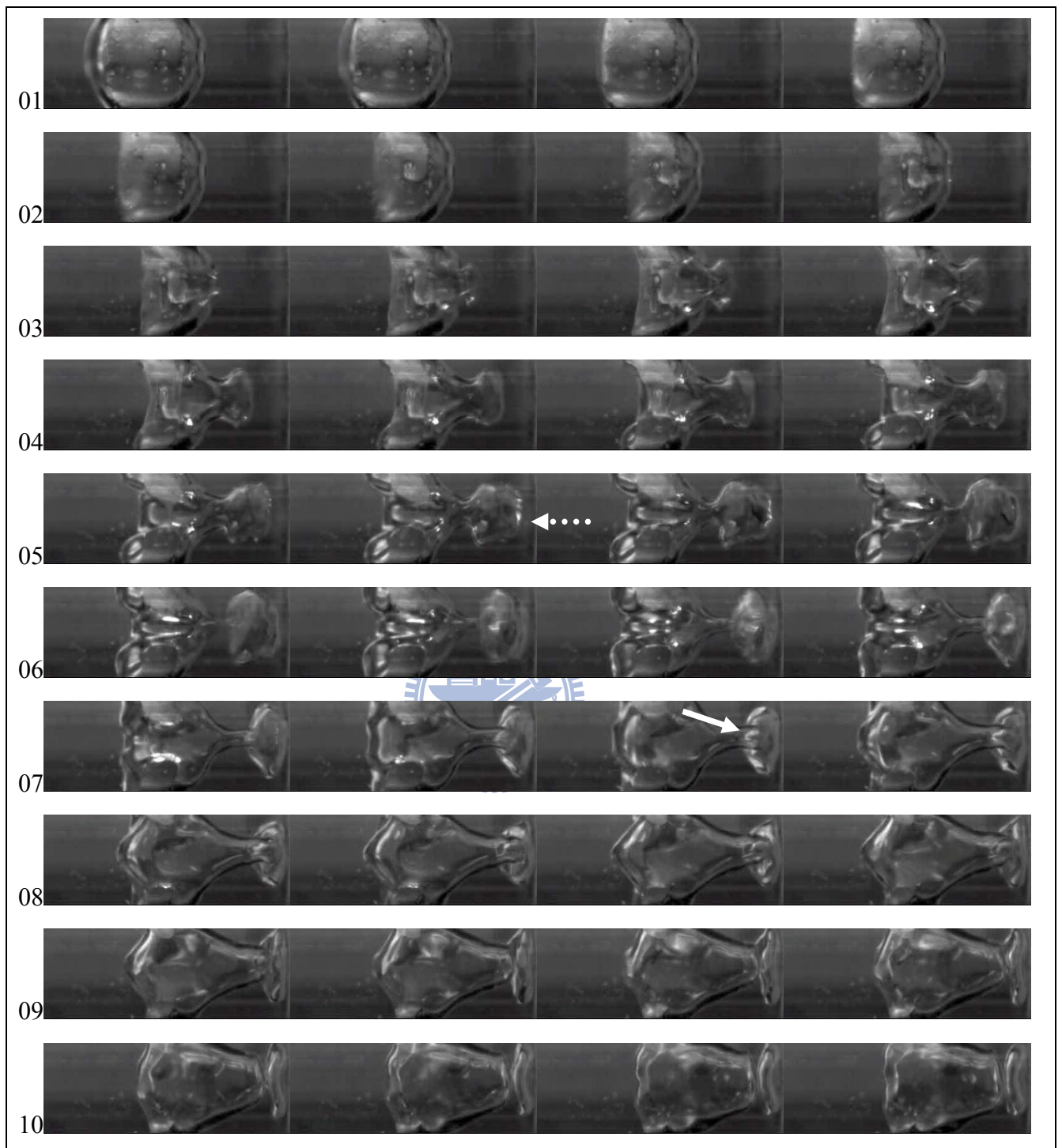
圖 4-19 震波壓力增強後距離參數 \gamma \approx 3 之穴蝕氣泡破裂過程影像；K-H 渦流為虛線箭頭指示、逆向噴流為實線箭頭指示；壓力波強度為 260kPa，影像時間間距為 1/4000 秒，影像大小為 9.6 mm×3.1 mm，氣泡最大半徑為 2.25 mm。
