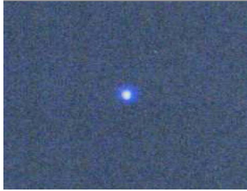
圖 1-5 氣泡破裂產生之發光現象，影像大小為 1mm×1mm (影像摘自 Lauterborn et al. 2007)
