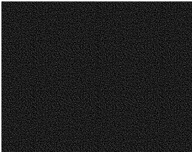
圖 2.8 azt.tm 拼湊出的 Kinect 完整投影圖案。
