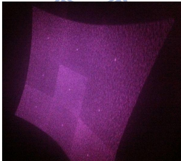
圖 2.7 Kinect 投影的紅外線光點圖案。
