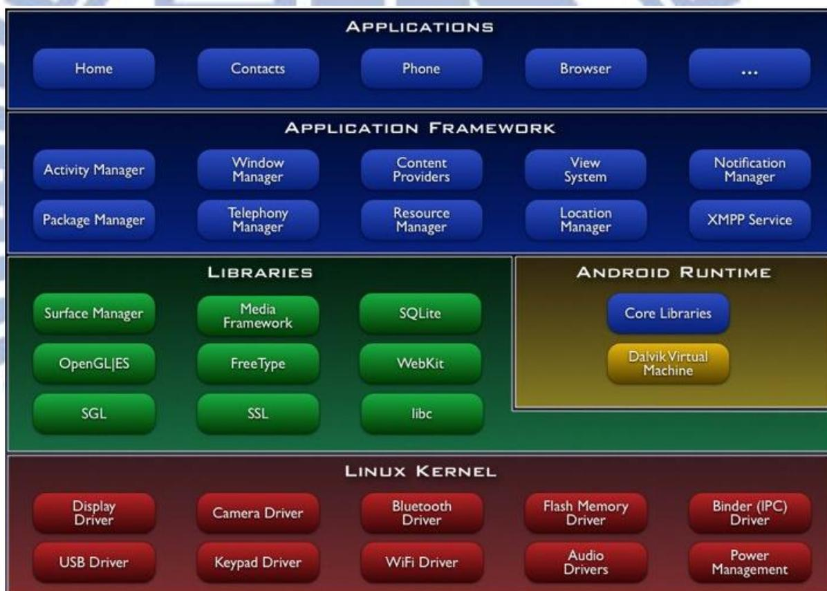
圖 1.3 Android 作業系統架構
