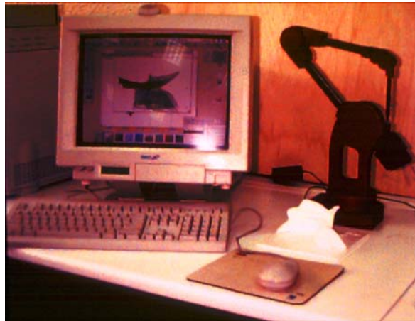
Figure 2.9 利用 3d digitizer 將實體模型輸入電腦
