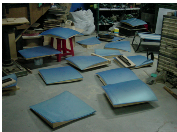
Figure 2.21 公信電子大廳面材真空成型
