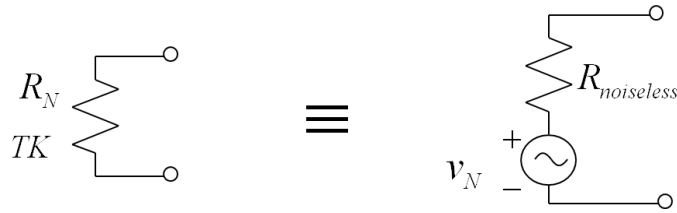
圖 3.1 電阻等效一雜訊電壓源
