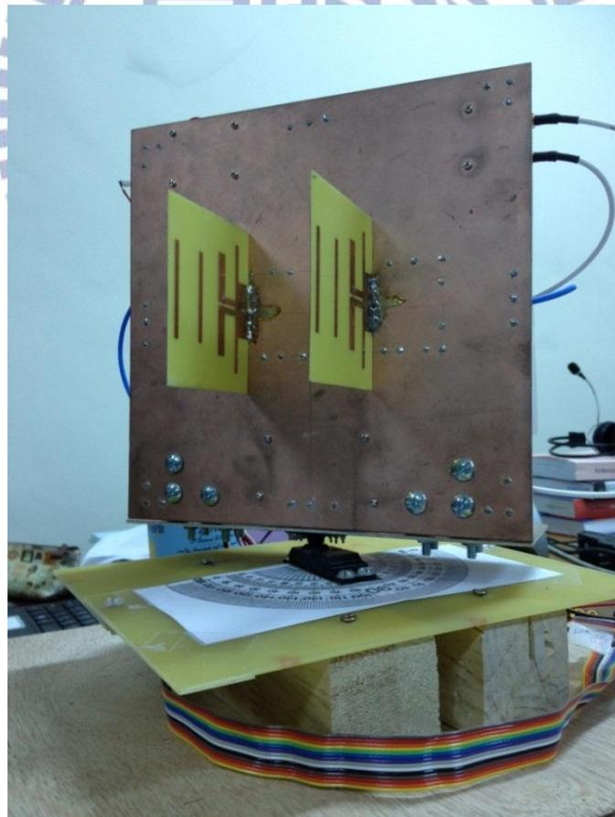
圖 3-2 振幅探測器實際成品正視圖
