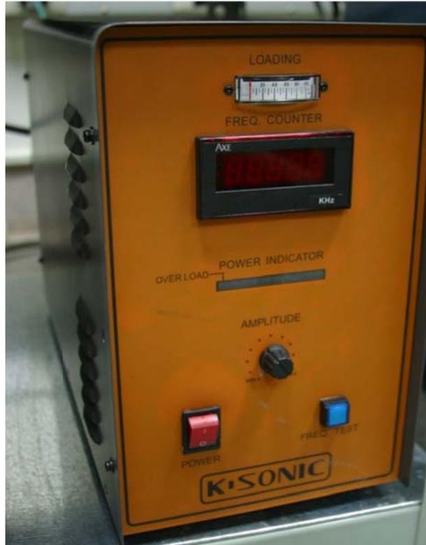
圖 2-3：35KHz 電子訊號產生器(京華超音波，KUS-35)
