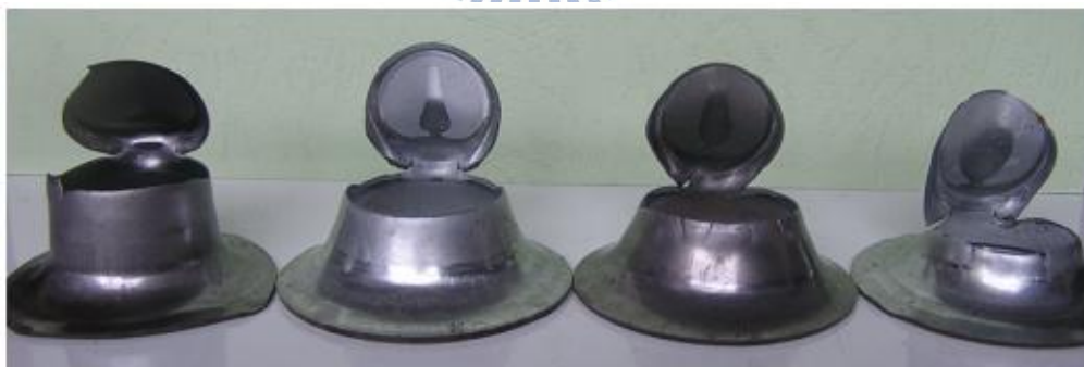
圖 1.8 引伸極限試驗材料破裂情形，材料由左至右為 (SPFC340, DP600, DP800, DP1000) [6]
