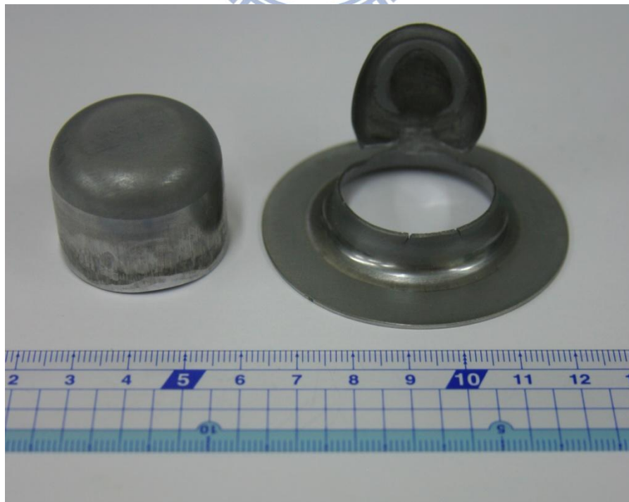
圖 3.6 引伸成品破裂情形（左：無破裂右：已破裂）
