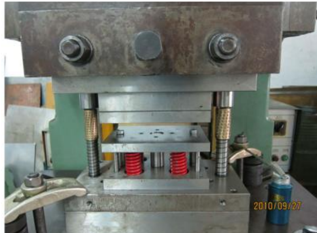
圖 1.7 引伸極限試驗模具配置圖[6]
