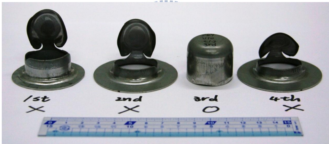
圖 3.13 直徑 64mm，無脈波曲線 壓料間隙 1.2mm，雙面潤滑之成形結果。
