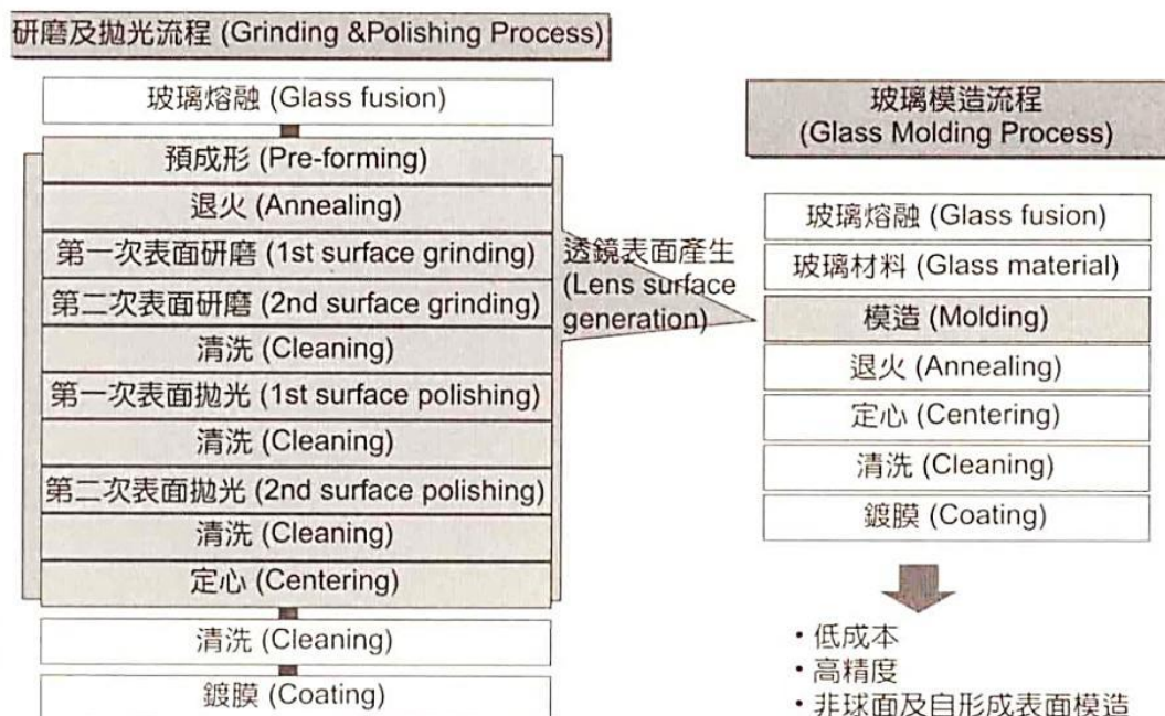
圖 1.5 傳統玻璃透鏡製作技術與玻璃模造成形技術製程比較[2]
