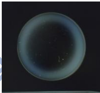
圖 6.18 模造溫度 568°C、降溫曲線 0.5°C/s (組別 2)
