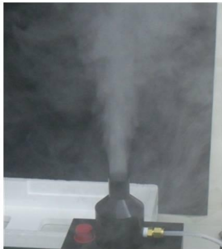
圖 3-6 粒子噴灑器設備以及測試圖 (粒子來源:飽和糖水溶液)
