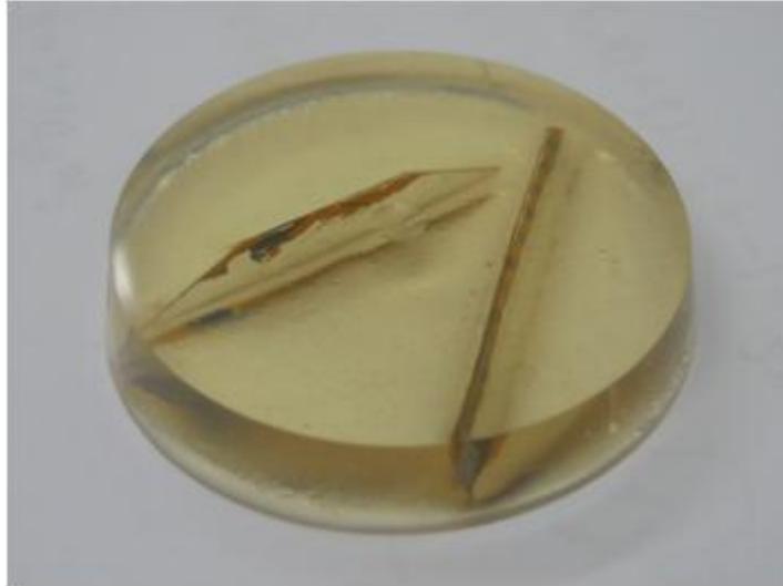
圖3.7 AE-PFC 冷鑲埋示意圖
