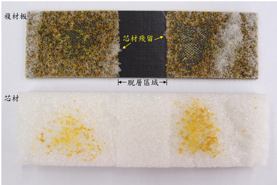
圖 2.14 具 30mm 脫層之 [(0/90)_2]_s 複材三明治結構分離後的表層與芯材
