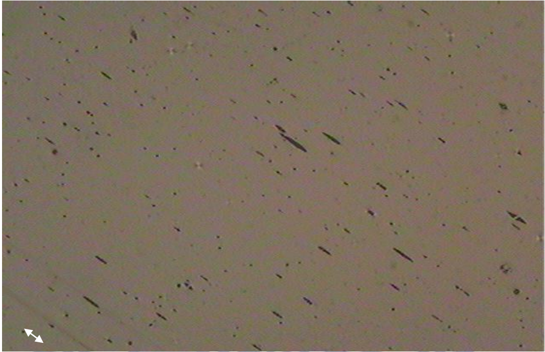
圖 4.14 延伸溫度 135°C，延伸倍率 5 倍，馬達轉速 20 rpm， 100X
