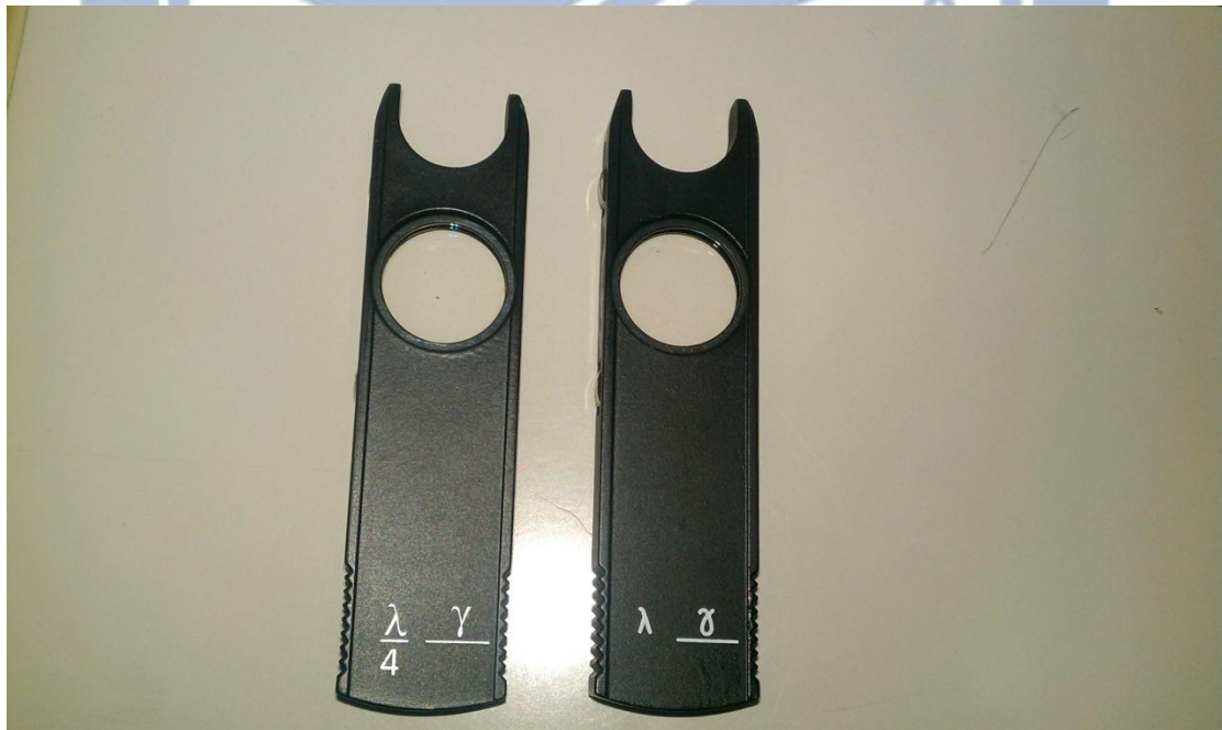
圖 3.7 左為 \lambda/4 補償板，右為 \lambda 補償板
