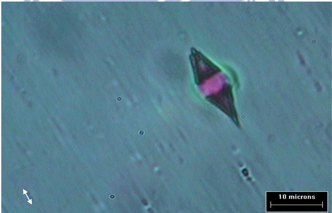
圖 4.13 延伸溫度 135°C，延伸倍率 5 倍，馬達轉速 10 rpm， 1000X
