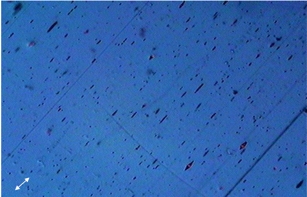
圖 4.12 延伸溫度 135°C，延伸倍率 5 倍，馬達轉速 10 rpm， 100X
