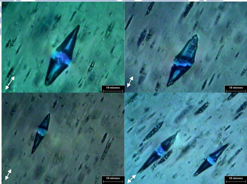
圖 4.27 延伸倍率 5 倍，馬達轉速 40 rpm，延伸溫度 95°C， 1000X
