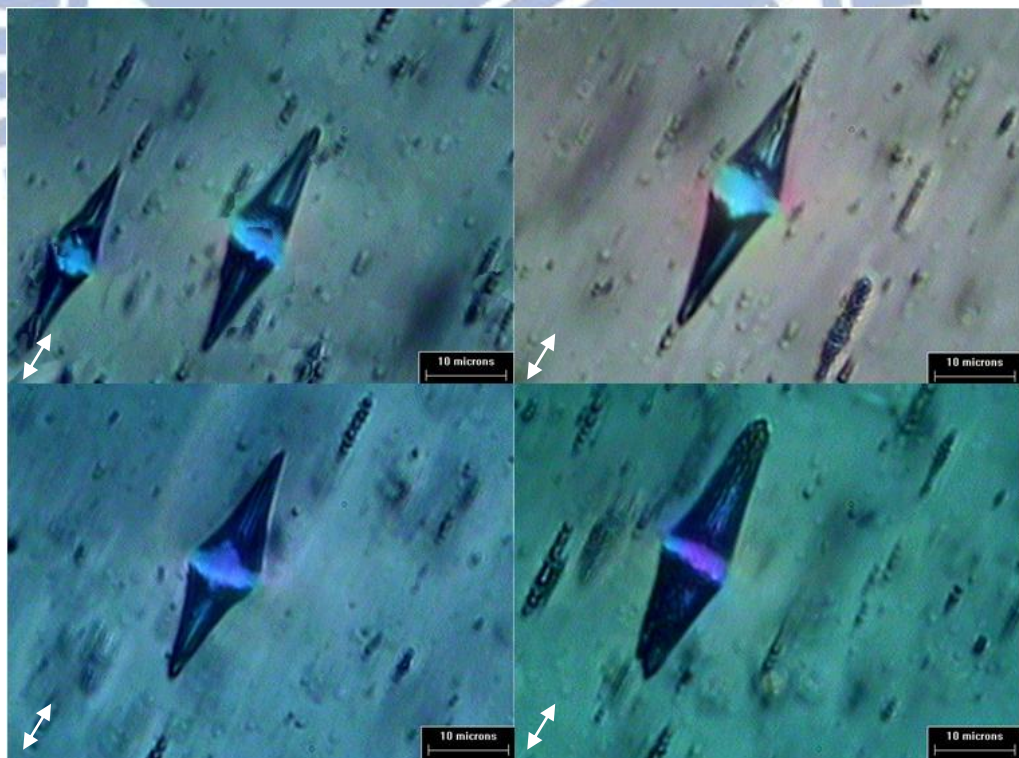
圖 4.29 延伸倍率 5 倍，馬達轉速 40 rpm，延伸溫度 115°C， 1000X
