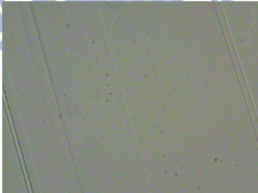
圖 4.1 未做延伸加工的原始試片在 POM 下之照片
