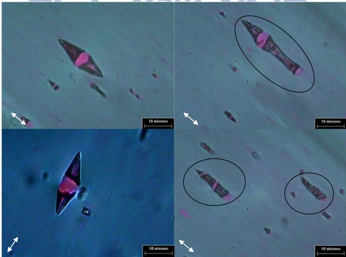
圖 4.7 延伸溫度 135°C、馬達轉速 40 rpm、延伸倍率 5 倍、1000X
