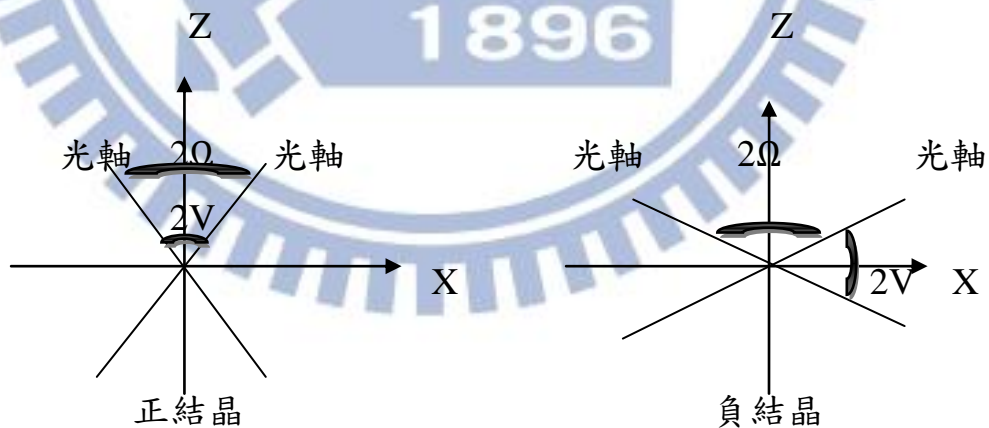
圖 2.8 二軸性結晶的正結晶與負結晶。
