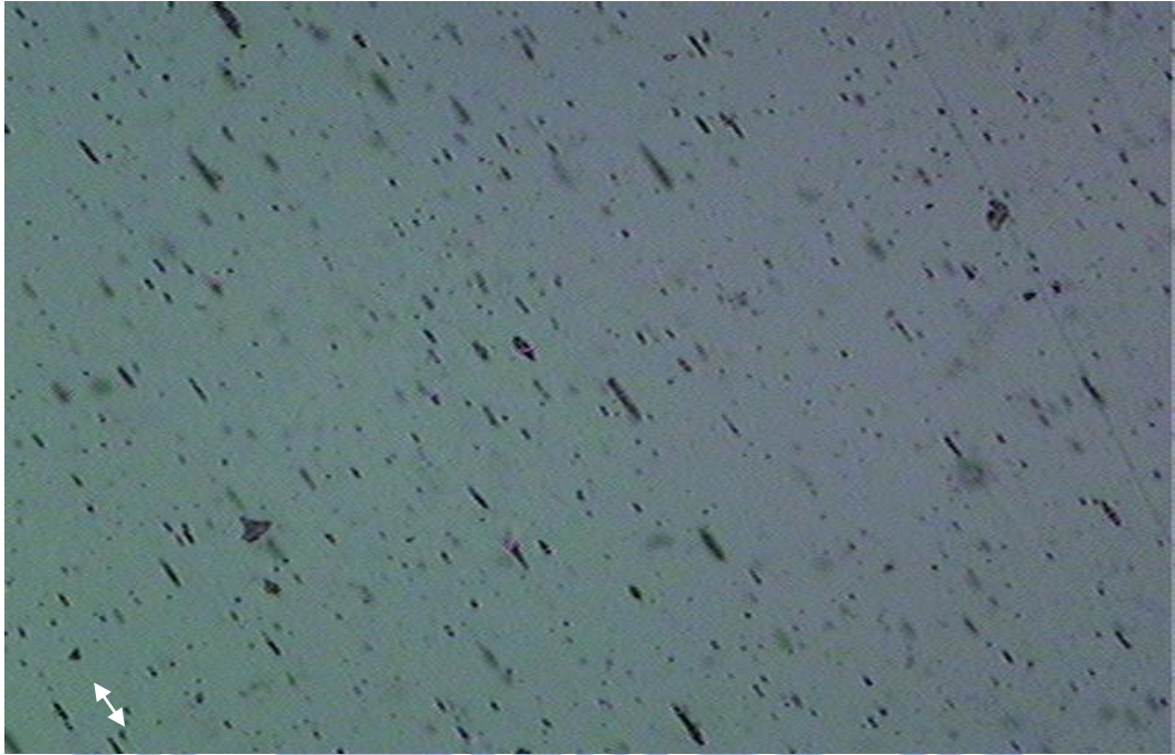
圖 4.16 延伸溫度 135°C，延伸倍率 5 倍，馬達轉速 30 rpm， 100X
