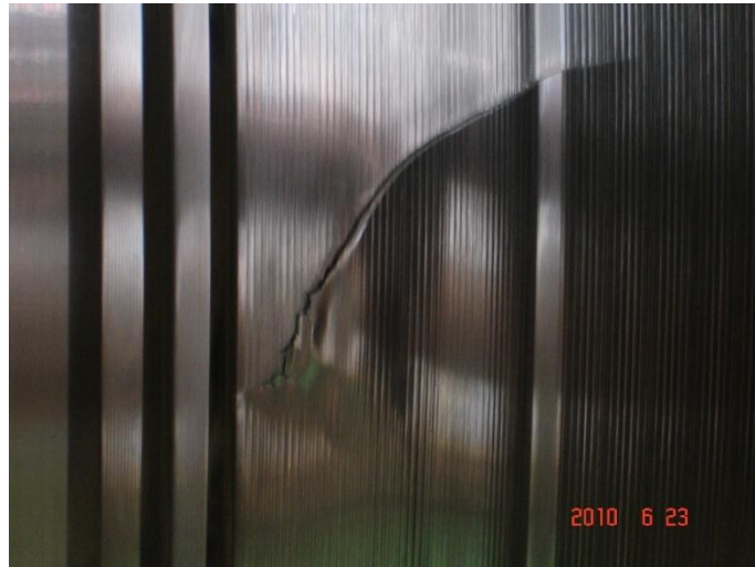
圖 44 50%旋形量加工所產生之裂痕
