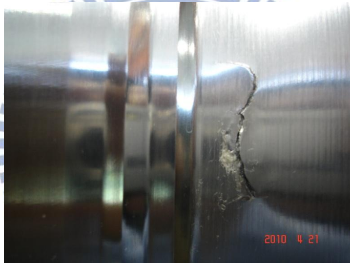
圖 44 50%旋形量加工所產生之裂痕
