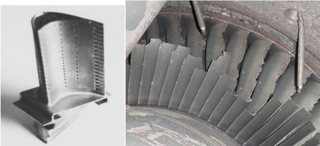
圖1-1：高溫的工作環境造成葉片損壞
