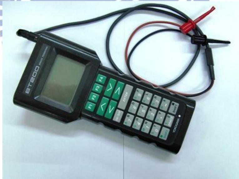
圖 2-6 BT200 : YOKOGAWA 公司製造，手持式，將差壓計歸零，保持電壓訊號輸出的準確性。
