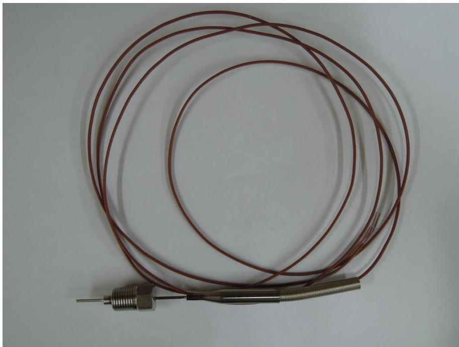
圖 2-7 包覆式熱電耦 [Thermocouple]: 量測進口水溫。
