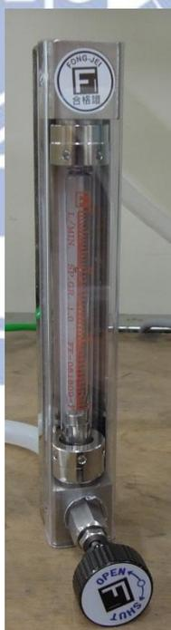
圖 2-8 浮子式流量計 [Rotameter]: 欣川公司製造，流量範圍為 0.1~1 l/min。
