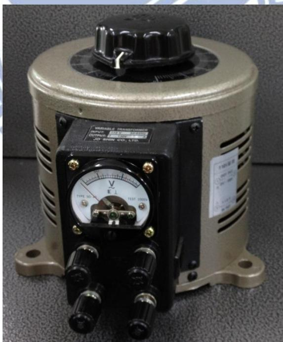
圖 2-12 自耦變壓器[variable transformer]: 久鑫公司製造，輸入 110V，輸出 0~130V，15A。
