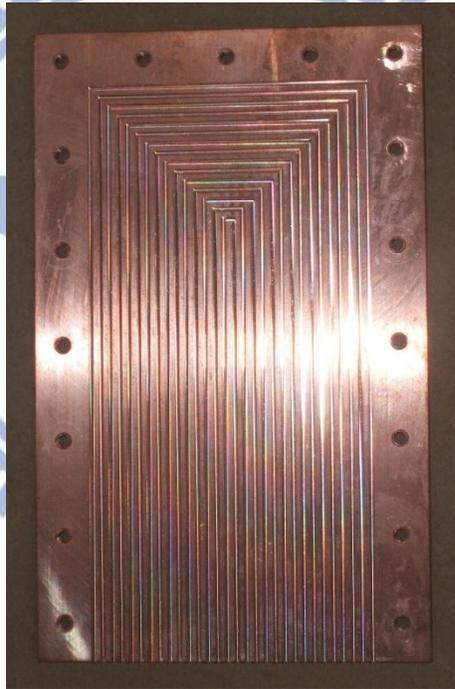
圖 2-20 微通道 流道尺寸 1mm×1mm
