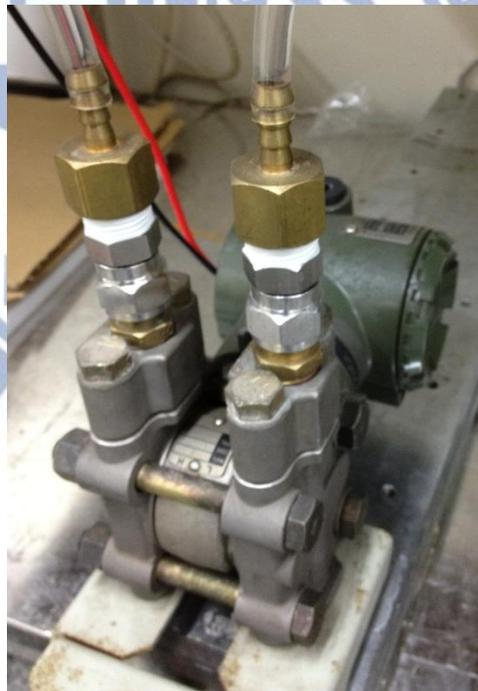
圖 2-4 差壓計[Differential Pressure Transmitter]: YOKOGAWA 公司製造，型號為 EJA110-DM，實驗中量測範圍為  $0\sim 0.5\text{kgf/cm}^2$
