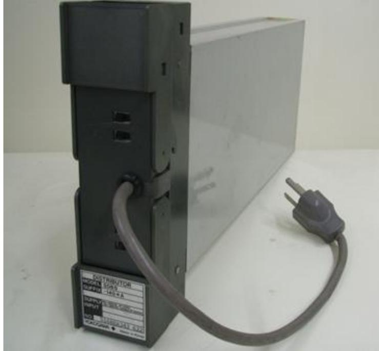
圖 2-5 分配器 [Distributor]: YOKOGAWA 公司製造，型號為 SDBS，將差壓計輸出的電流訊號，轉換為電壓訊號輸出。
