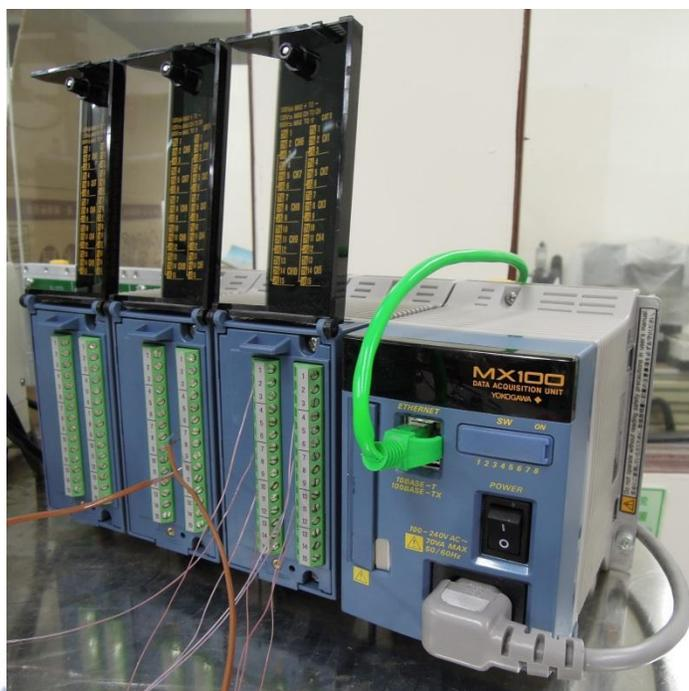
圖 2-11 MX100[Hybrid Recorder]: YOKOGAWA 公司製造，可連接電腦進行資料擷取。
