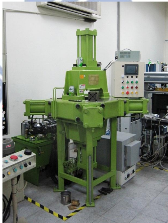
圖 3- 2 連續式六向等徑轉角反覆擠製機具
