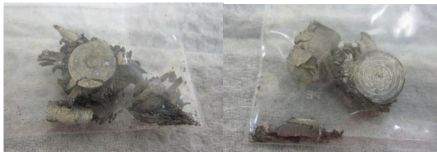
圖 4- 17 ECAE 在 480°C 30 秒持溫之壓縮結果
