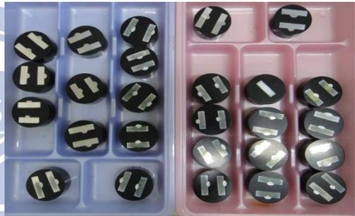
圖 3-10 腐蝕完成之試片
