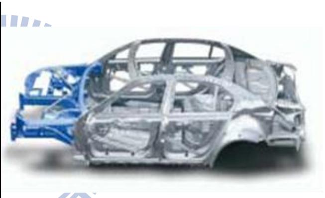
(b) 前端鋁化之鋼/鋁混合車體
