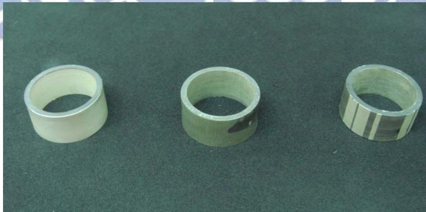
圖 4.6 PZT-4 壓電圓管(從左至右依序為清洗電極前、後及佈好設計之電極)
