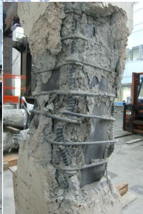
圖 5-23 試體 SN3 載重試驗後損害情形
