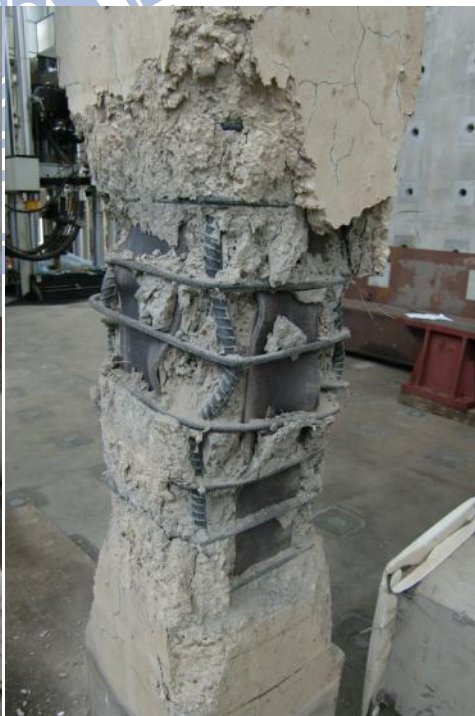
圖 5-24 試體 SH3 載重試驗後損害情形
