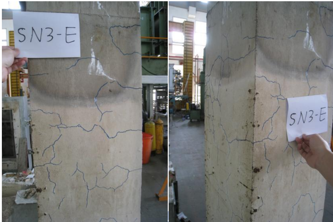
圖 5-7 試體 SN3 高溫試驗後損害情形(續)
