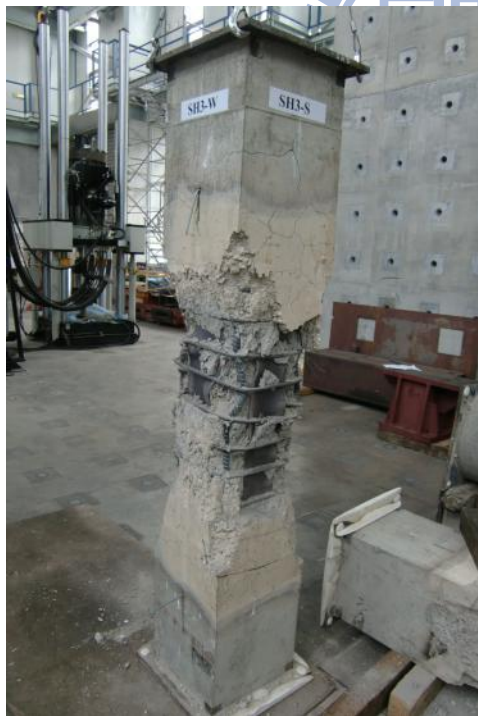
圖 5-24 試體 SH3 載重試驗後損害情形
