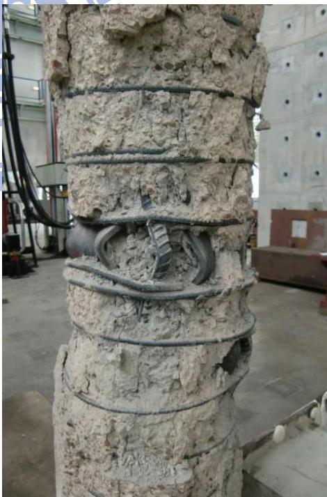
圖 5-25 試體 CN2 載重試驗後損害情形
