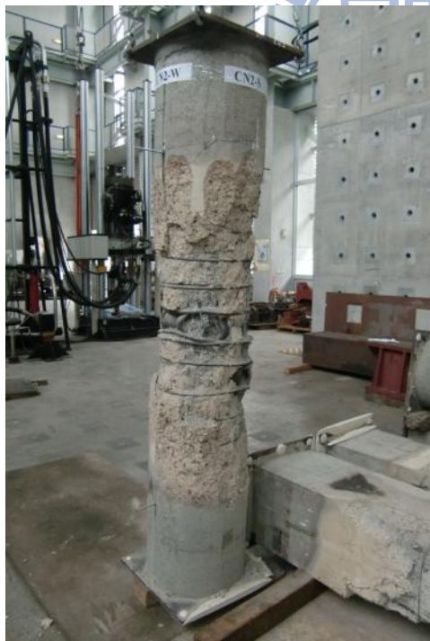
圖 5-25 試體 CN2 載重試驗後損害情形
