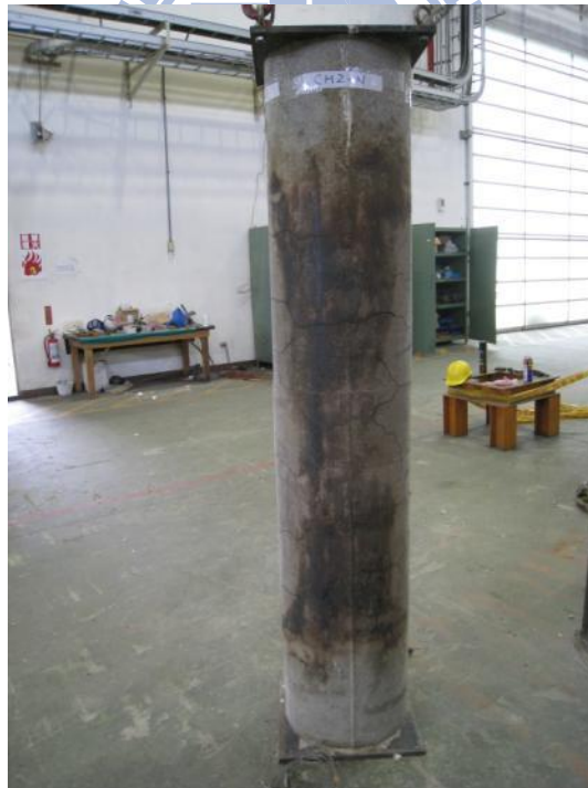
圖 5-10 試體 CH2 高溫試驗後損害情形
