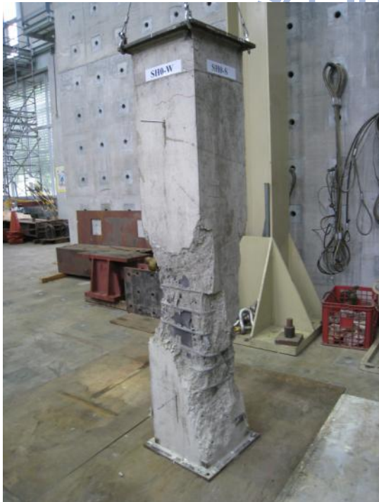
圖 5-20 試體 SH0 載重試驗後損害情形
