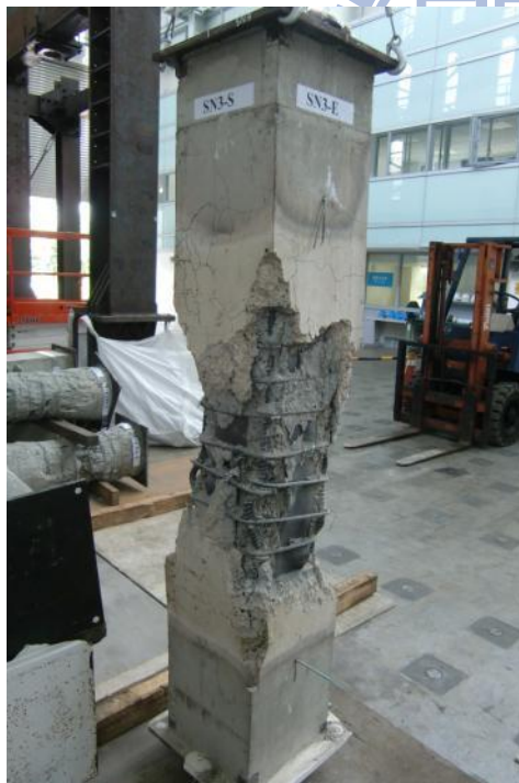
圖 5-23 試體 SN3 載重試驗後損害情形
