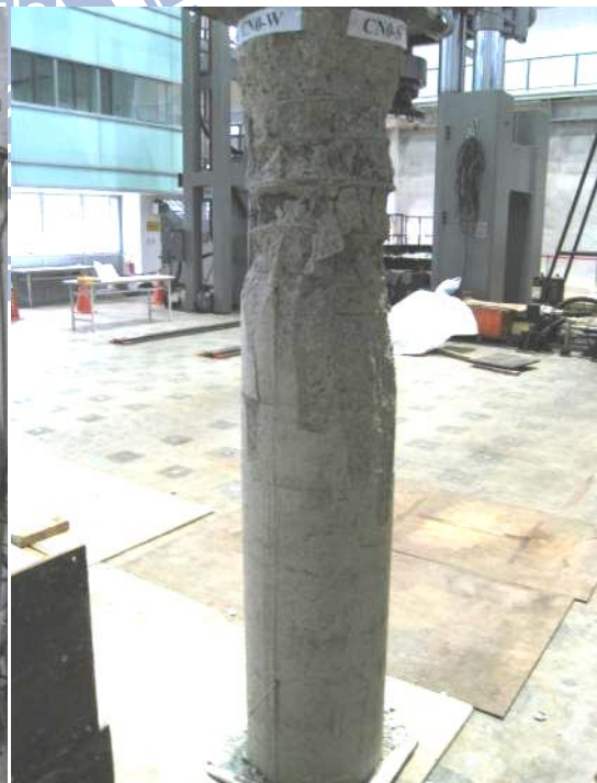
圖 5-21 試體 CN0 載重試驗後損害情形
