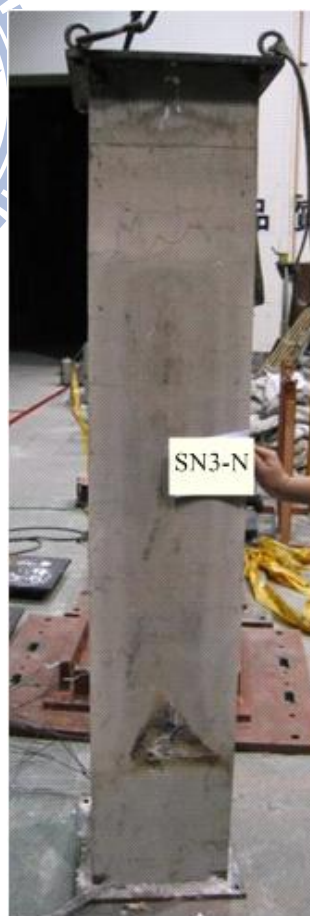
圖 5-7 試體 SN3 高溫試驗後損害情形
