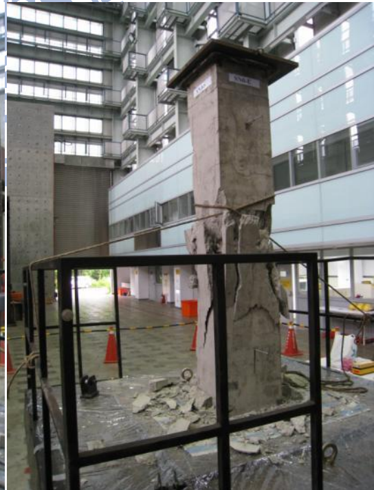
圖 5-19 試體 SN0 載重試驗後損害情形
