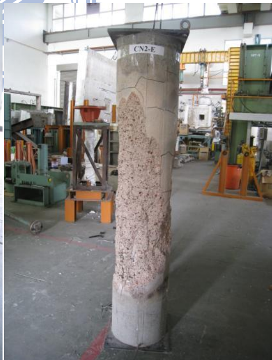
圖 5-9 試體 CN2 高溫試驗後損害情形
