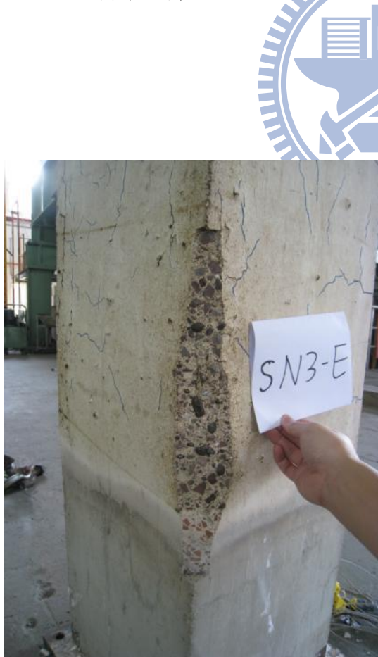
圖 5-7 試體 SN3 高溫試驗後損害情形
