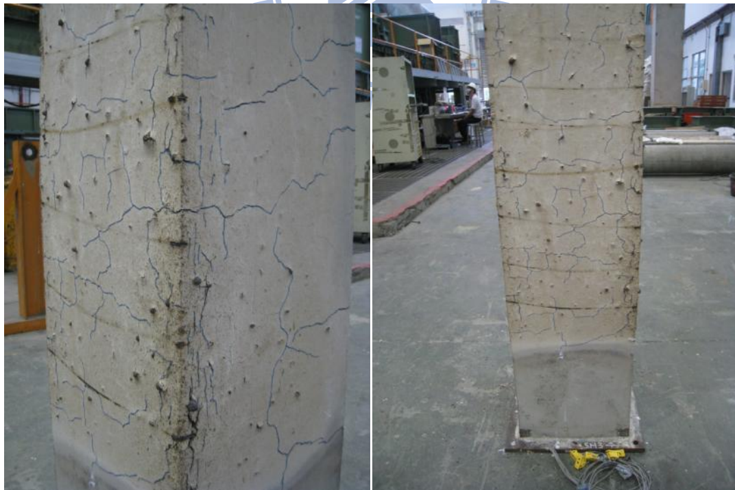
圖 5-8 試體 SH3 高溫試驗後損害情形
