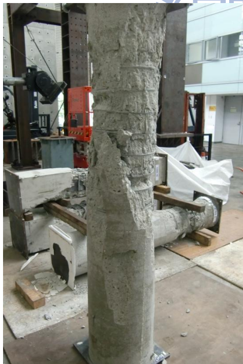
圖 5-22 試體 CH0 載重試驗後損害情形
