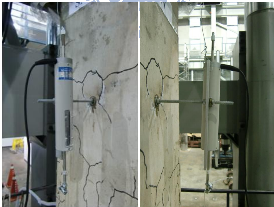
圖 4-4 載重試驗位移計架設圖
