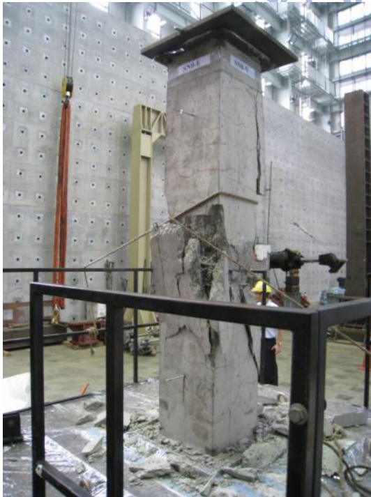
圖 5-19 試體 SN0 載重試驗後損害情形
