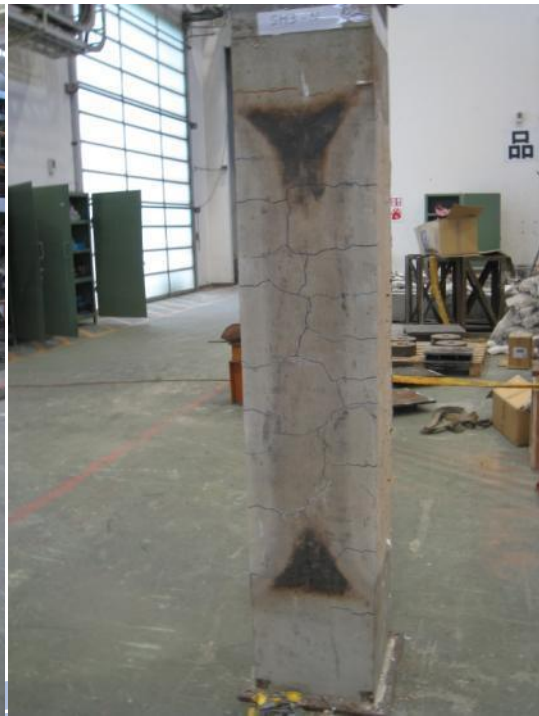
圖 5-8 試體 SH3 高溫試驗後損害情形(續)
