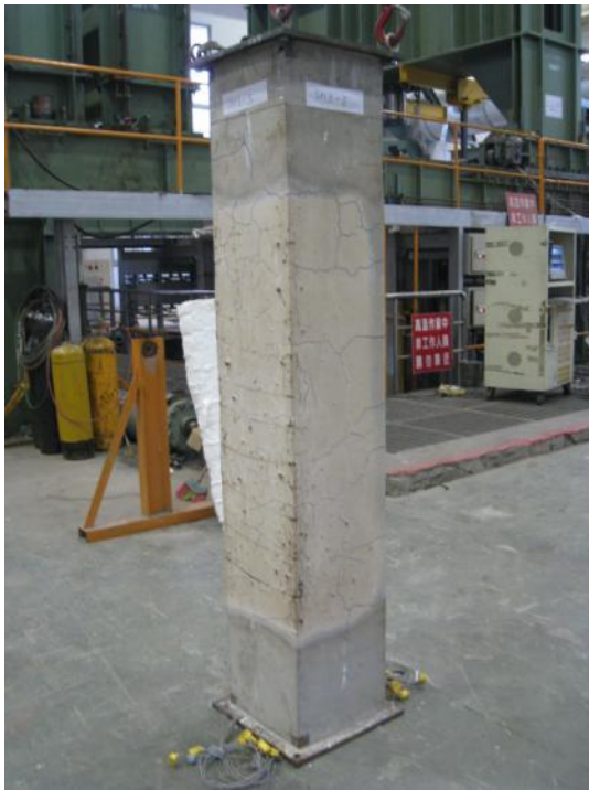
圖 5-8 試體 SH3 高溫試驗後損害情形(續)
