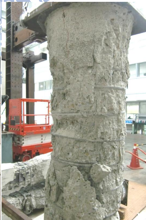
圖 5-22 試體 CH0 載重試驗後損害情形
