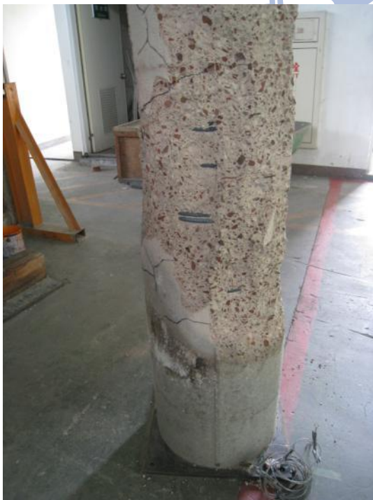
圖 5-9 試體 CN2 高溫試驗後損害情形
