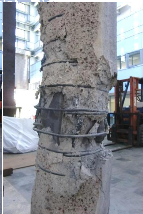
圖 5-26 試體 CH2 載重試驗後損害情形
