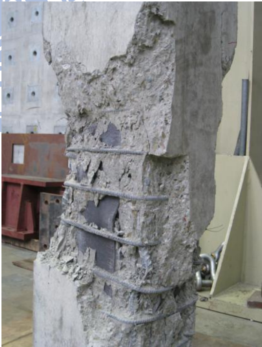
圖 5-20 試體 SH0 載重試驗後損害情形
