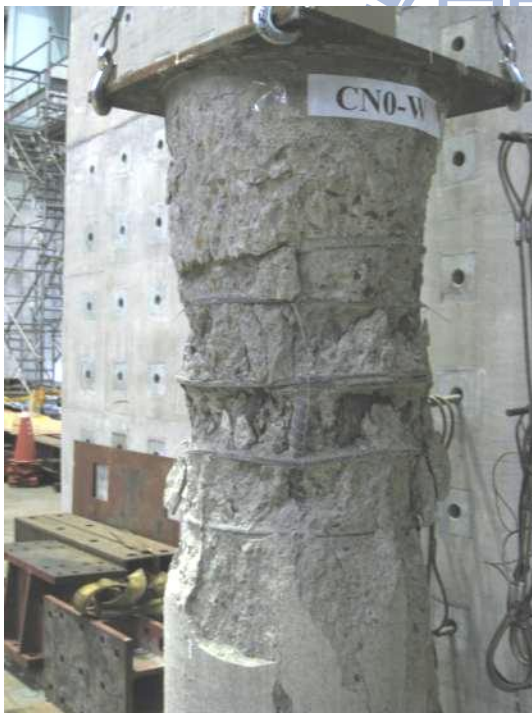
圖 5-21 試體 CN0 載重試驗後損害情形
