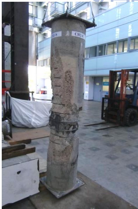
圖 5-26 試體 CH2 載重試驗後損害情形
