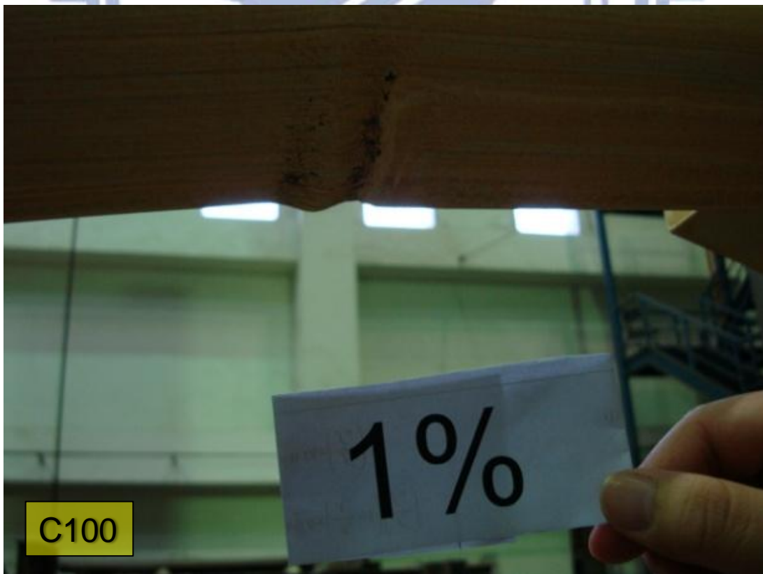
圖 4.53 試體 C100 斜撐南端局部挫屈情形(2) (DR=1%)
