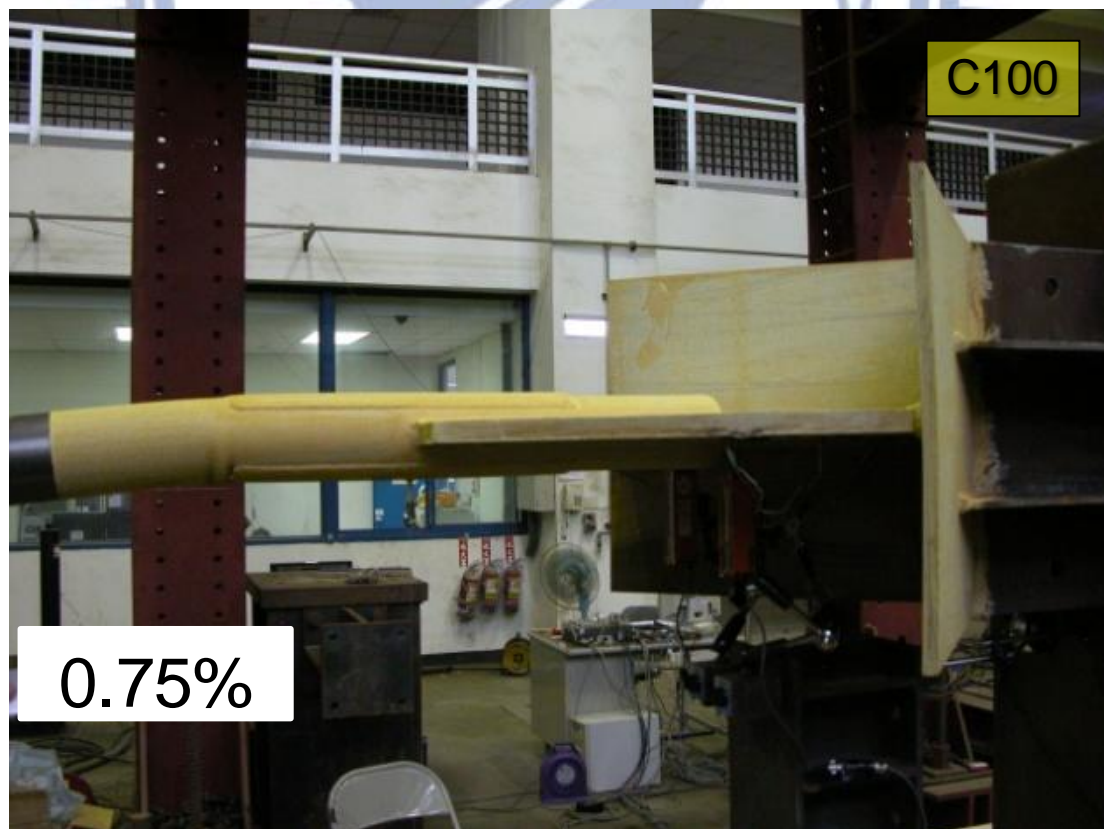
圖 4.49 試體 C100 斜撐北端局部挫屈情形(2) (DR=0.75%)
