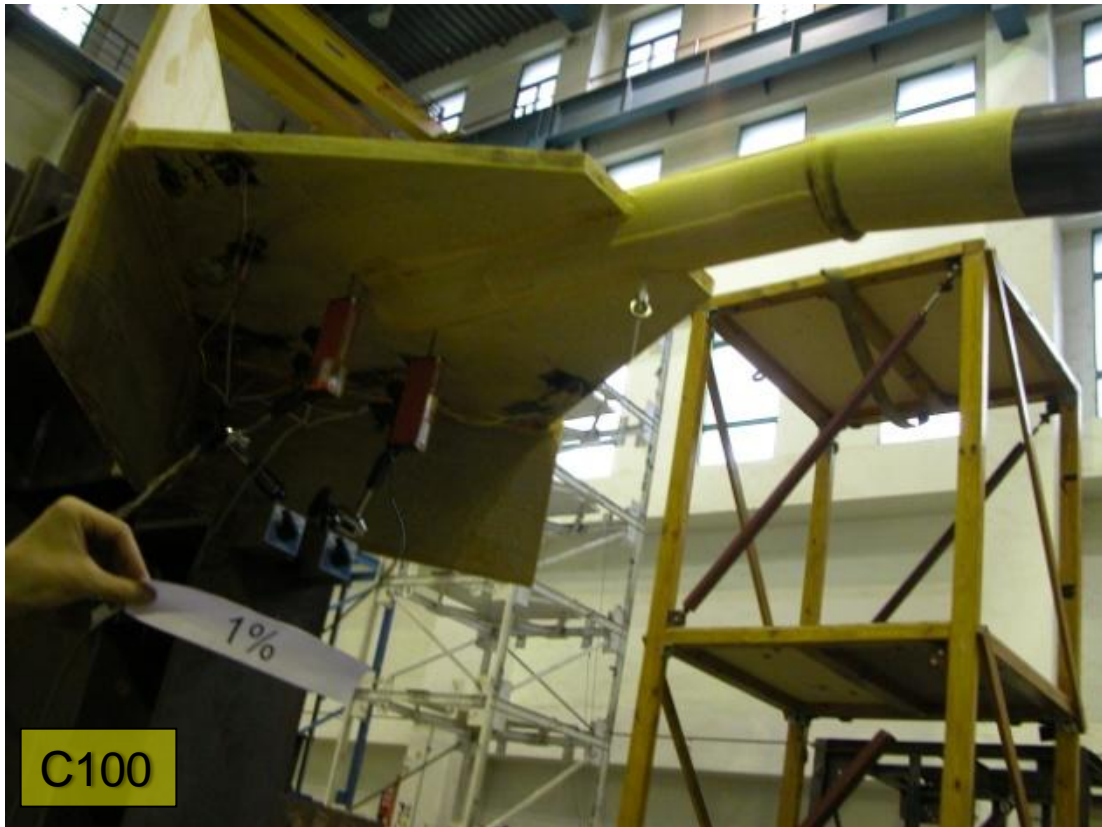
圖 4.54 試體 C100 斜撐北端局部挫屈情形(1) (DR=1%)
