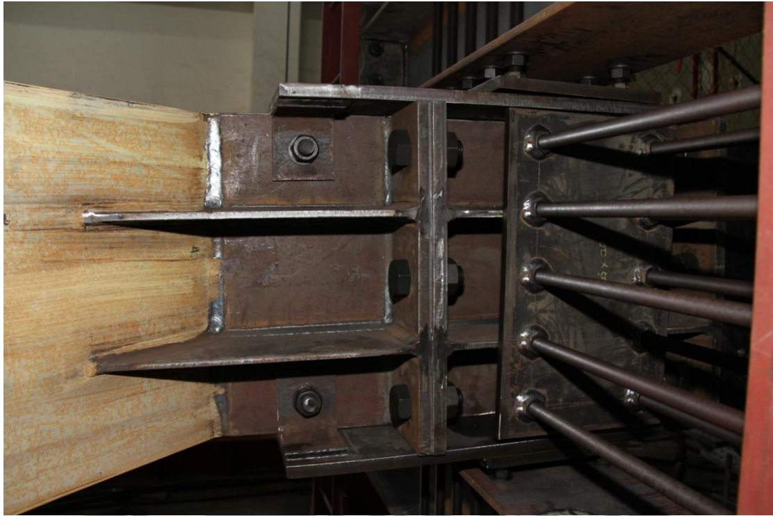
圖 4.14 油壓致動器施力軌道
