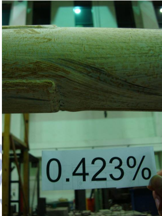
圖 4.28 試體 E100 斜撐北端發生局部挫屈情形(2) (DR=0.423%)
