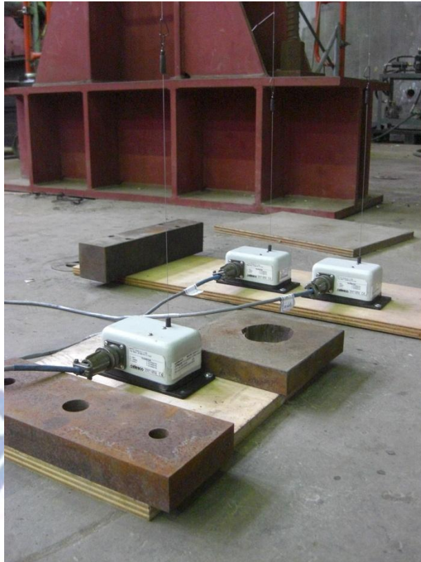
圖 4.16 拉線式位移計
