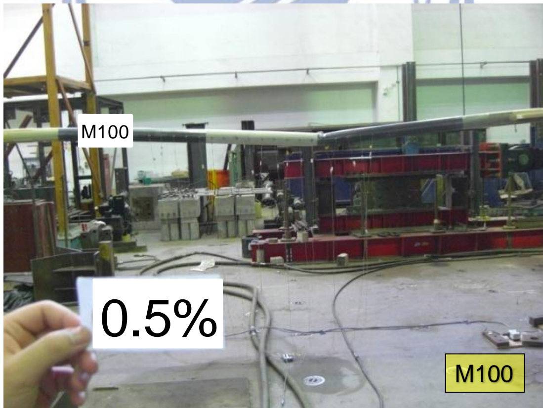
圖 4.21 試體 M100 斜撐中段發生局部挫屈情形(1) (DR=0.5%)
