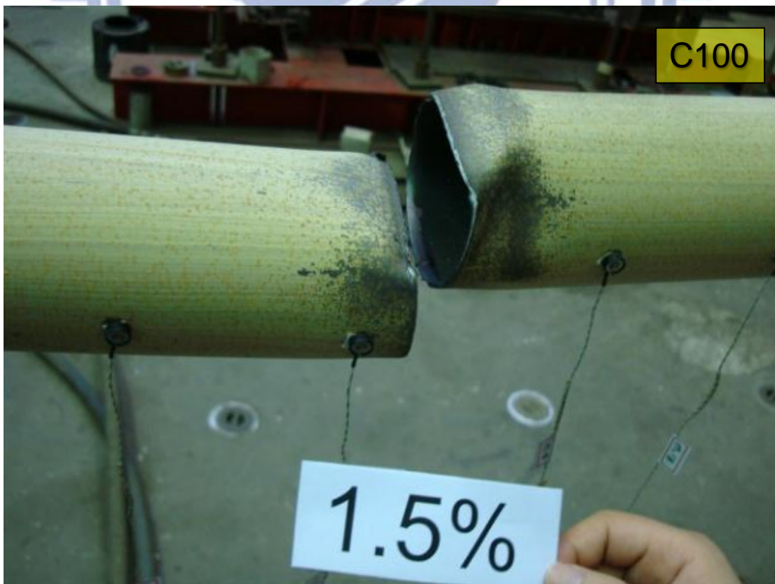
圖 4.57 試體 C100 斜撐斷裂情形(2) (DR=1.5%)
