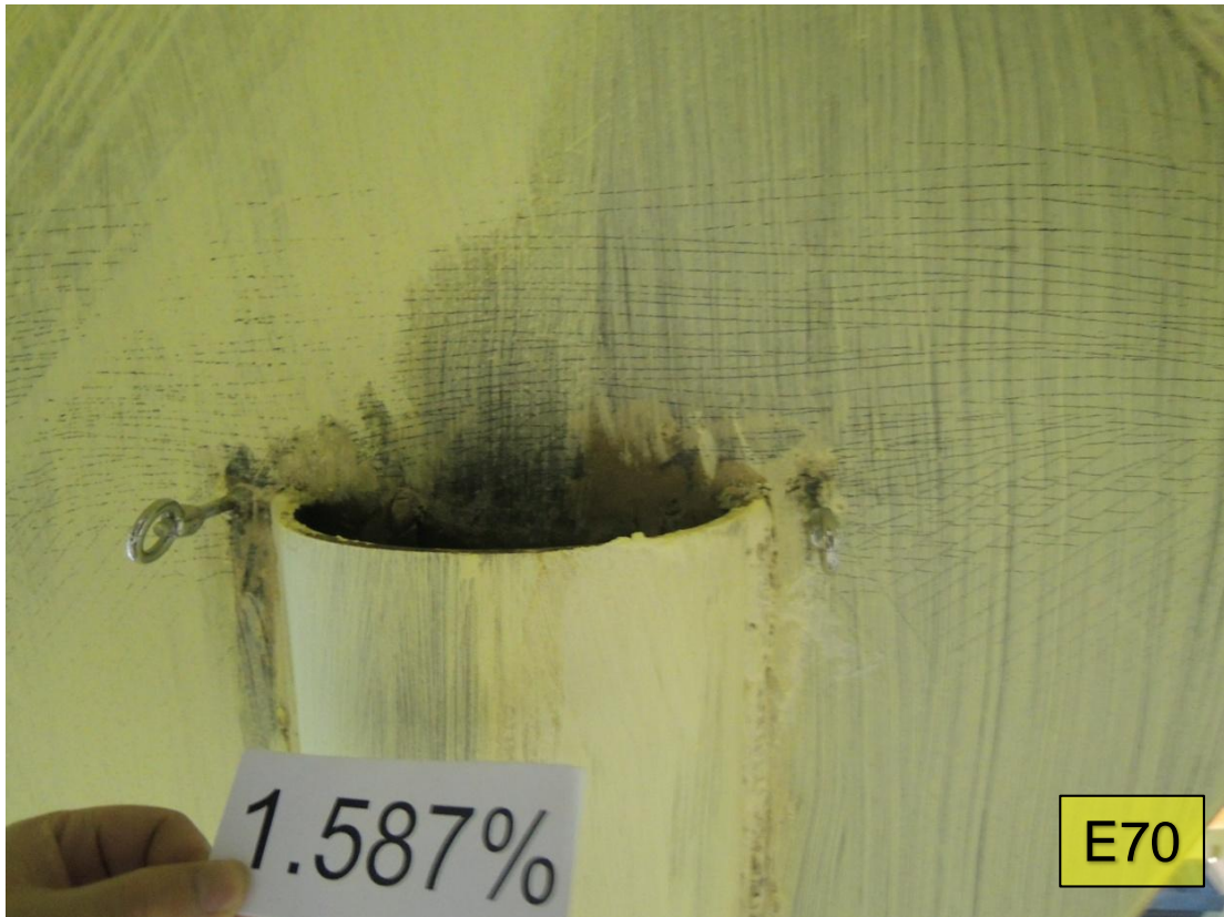
圖 4.76 試體 E70 斜撐南端接合板下緣石膏漆脫弱 (DR=1.587%)
