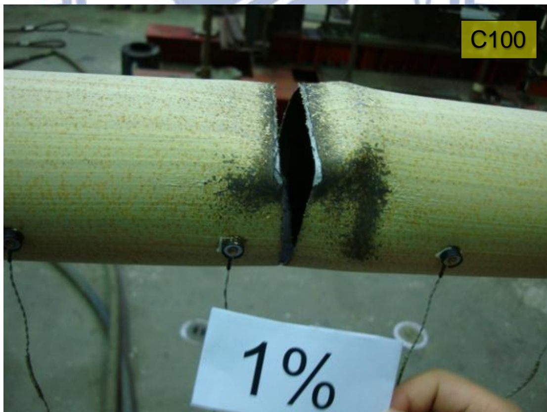
圖 4.51 試體 C100 斜撐中段開裂情形(2) (DR=1%)
