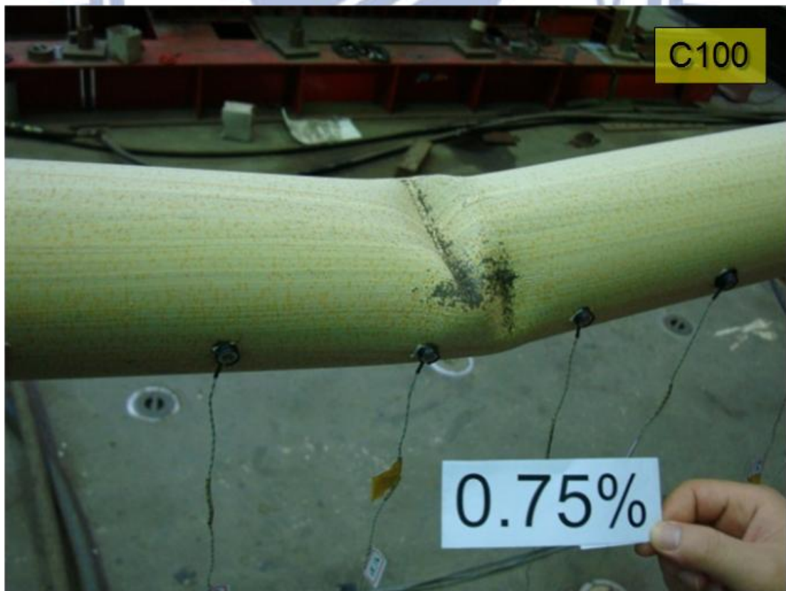
圖 4.47 試體 C100 斜撐中段局部挫屈情形(2) (DR=0.75%)
