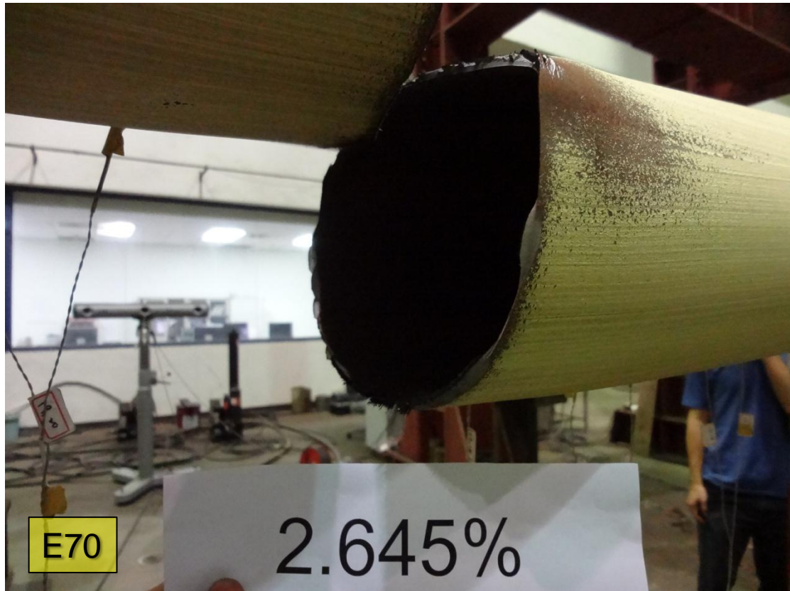
圖 4.78 試體 E70 斜撐斷裂情形(2) (DR=2.645%)
