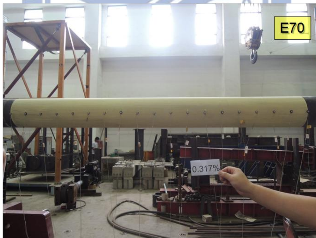
圖 4.69 試體 E70 斜撐達到最大抗壓強度 ( DR=0.317\% )
