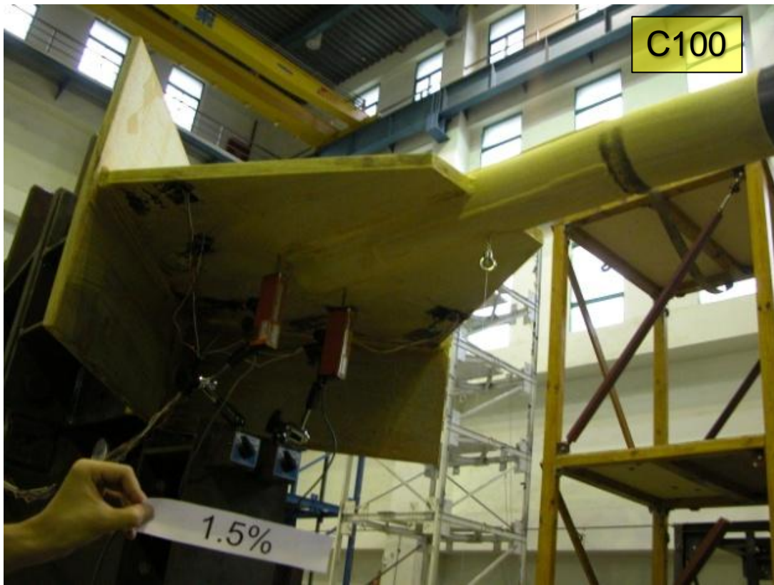
圖 4.58 試體 C100 斜撐北端局部挫屈情形 (DR=1.5%)
