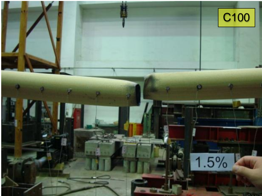
圖 4.56 試體 C100 斜撐斷裂情形(1) (DR=1.5%)
