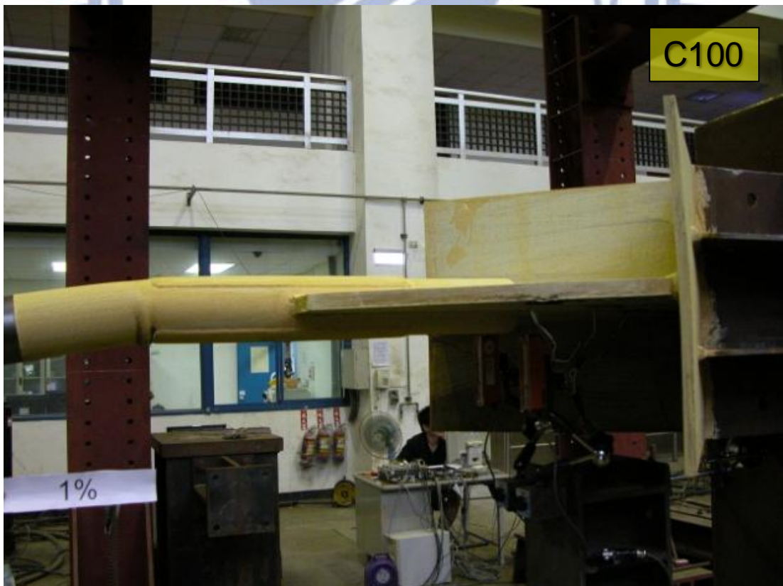
圖 4.55 試體 C100 斜撐北端局部挫屈情形(2) (DR=1%)
