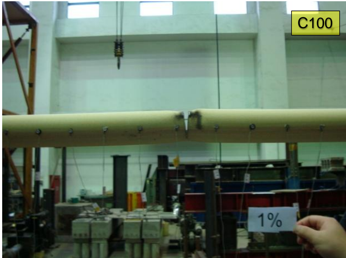
圖 4.50 試體 C100 斜撐中段開裂情形(1) (DR=1%)
