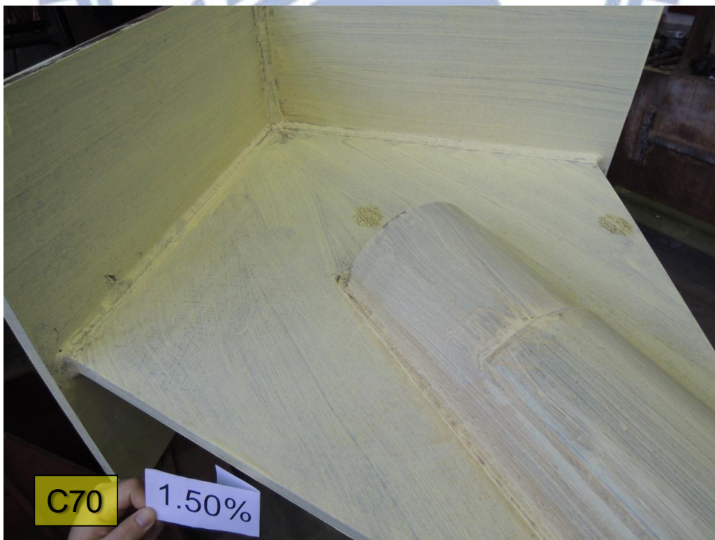
圖 4.87 試體 C70 斜撐南端接合板上緣石膏漆開始脫弱(1) (DR=1.5%)
