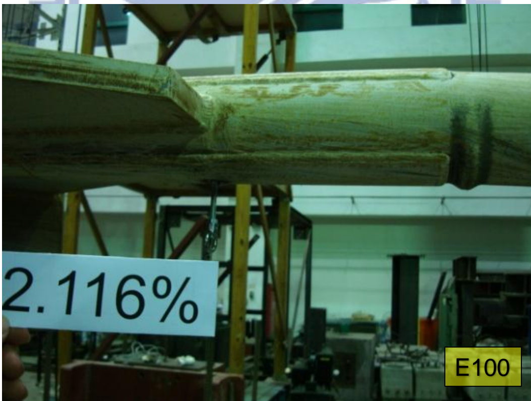
圖 4.39 試體 E100 斜撐北端局部挫屈情形 (DR=2.116%)
