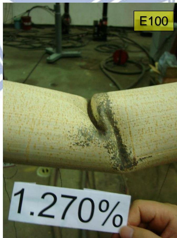
圖 4.35 試體 E100 斜撐中段局部挫屈情形 (DR=1.27%)
