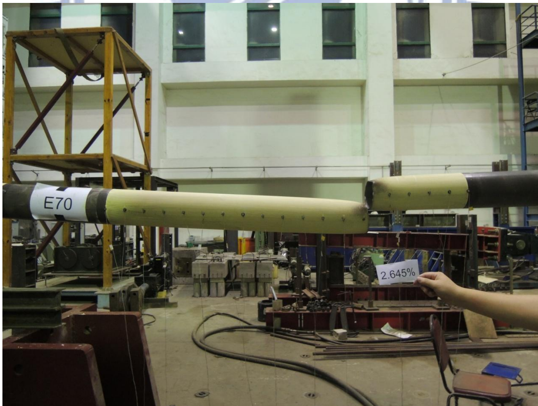
圖 4.77 試體 E70 斜撐斷裂情形(1) (DR=2.645%)
