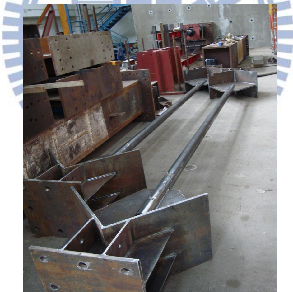
圖 4.3 試驗斜撐構件試體設計圖與實際組裝圖
