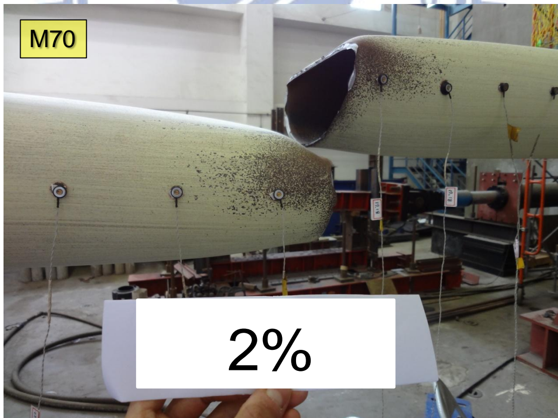
圖 4. 68 試體 M70 從斜撐斷裂情形(3) (DR=2%)
