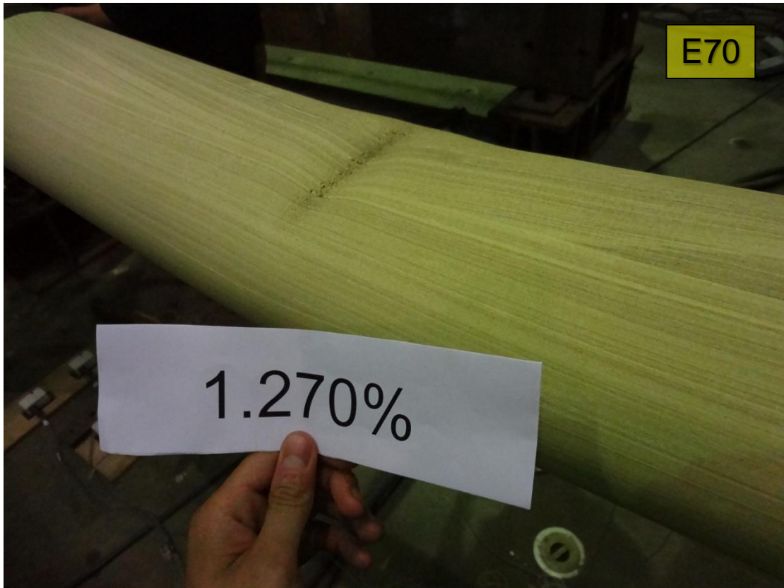
圖 4.74 試體 E70 斜撐中段發生局部挫屈(2) (DR=1.27%)
