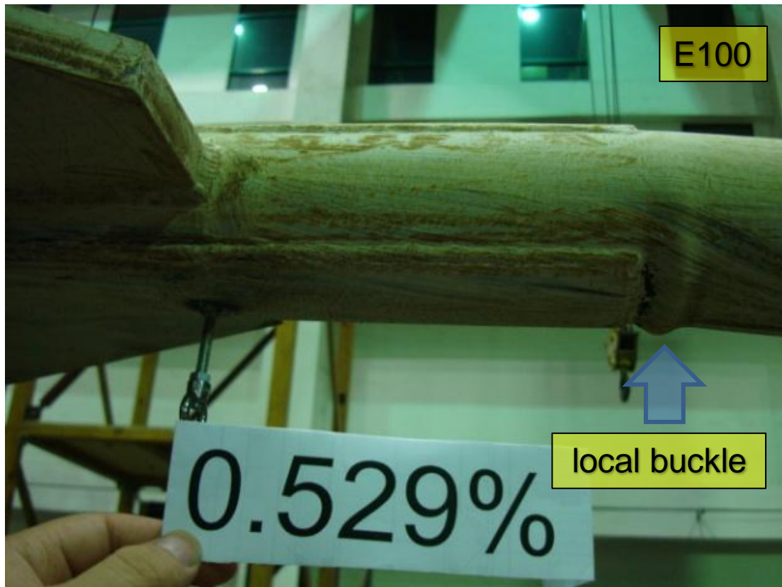
圖 4.30 試體 E100 斜撐斜撐北端發生局部挫屈情形 (DR=0.529%)
