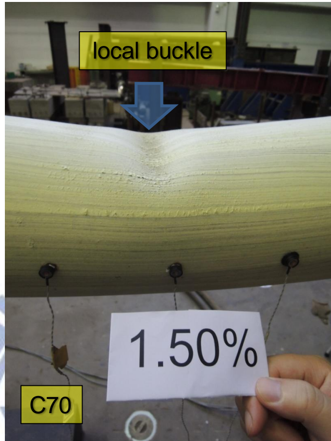
圖 4.86 試體 C70 斜撐中段發生局部挫屈(2) (DR=1.5%)
