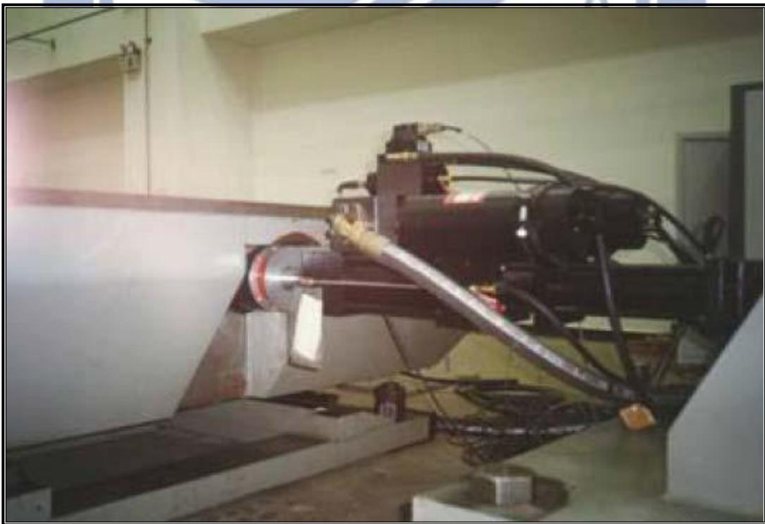
圖 4.2 振動台油壓致動器
