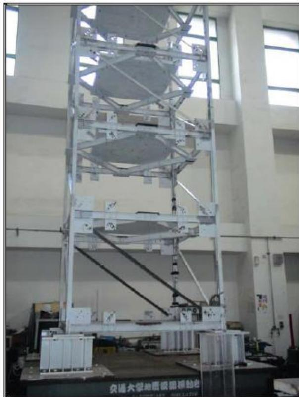
圖 4.7 五層樓鋼結構(二樓受損，移除弱軸雙邊斜撐)
