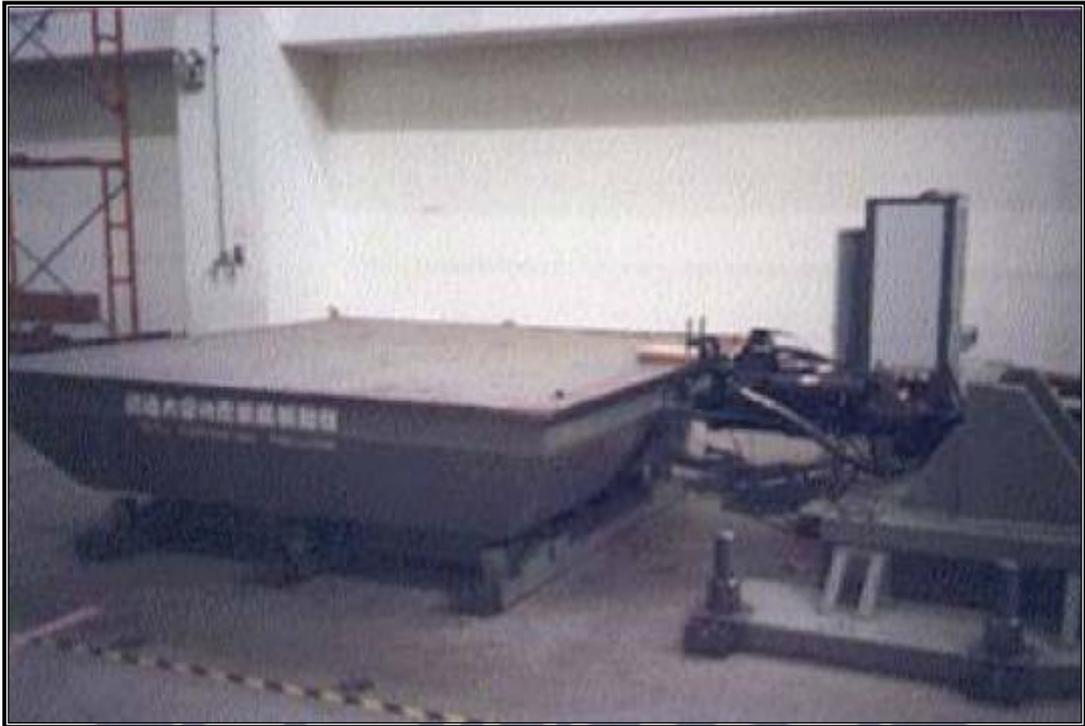
圖 4.1 地震模擬振動台
