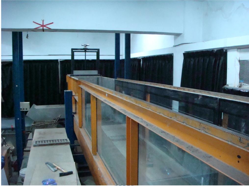
圖 3-1 可坡度大型明渠試驗水槽
