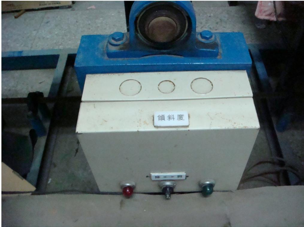
圖 3-3 傾斜度調整器
