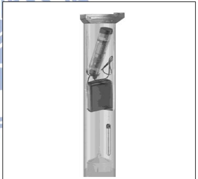
圖 1-2 電極觸針自記式水位計
