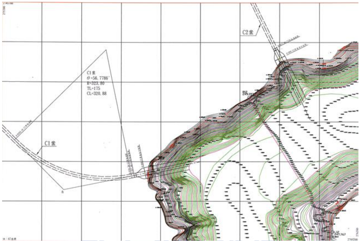
圖 1-8 石門水庫防洪防淤隧道 C 案工程平面佈置圖(資料來源：水規所)
