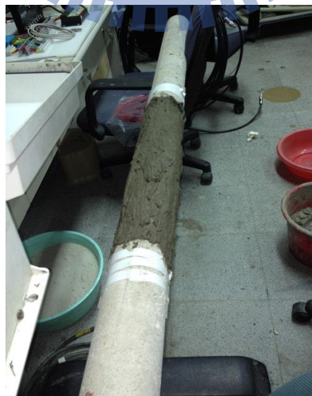
圖 3-12 土釘夾泥試驗過程
