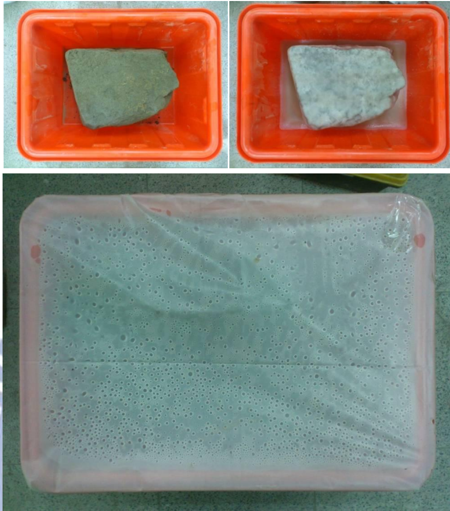
圖 4-2 將岩塊置入耐震橘桶以白蠟密封，再以 PVC 塑膠布密封
