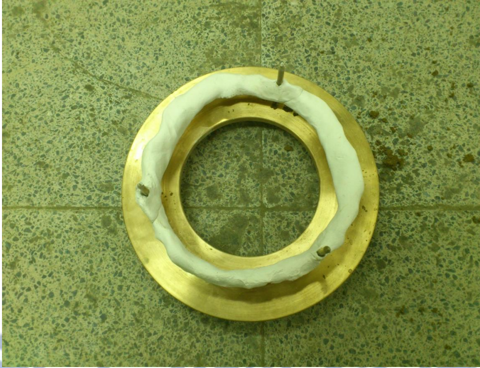
圖 5-3 使用防水黏土止水
