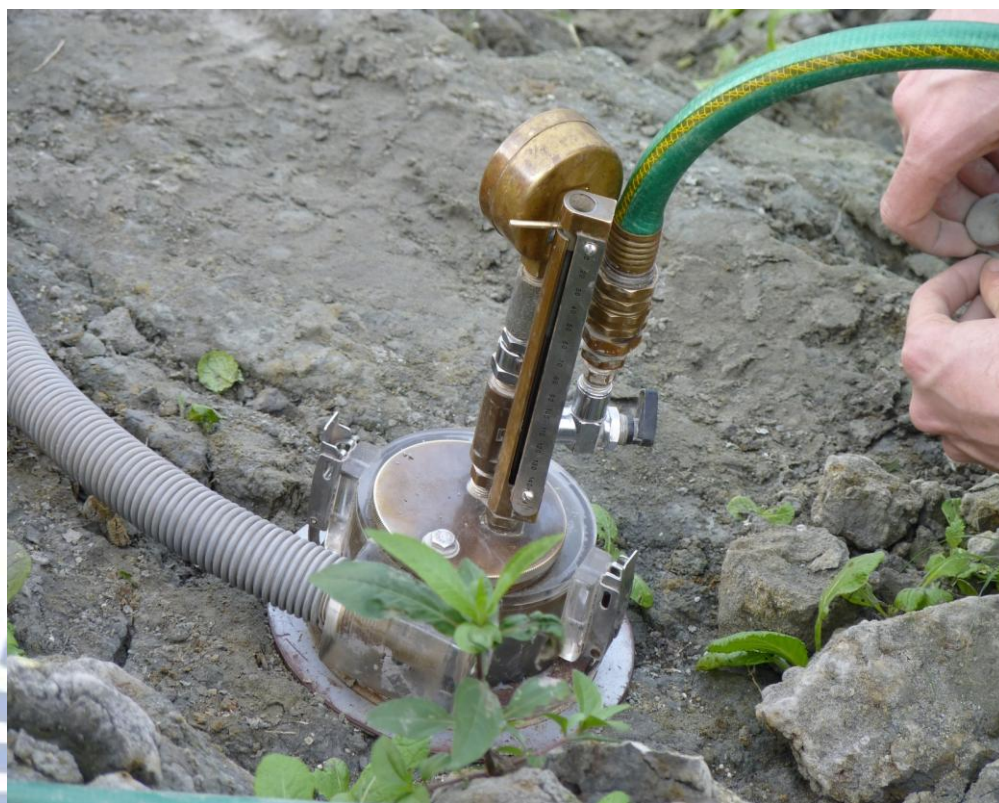
圖 2-29 Mini Jet 於現地試驗裝設完成圖
