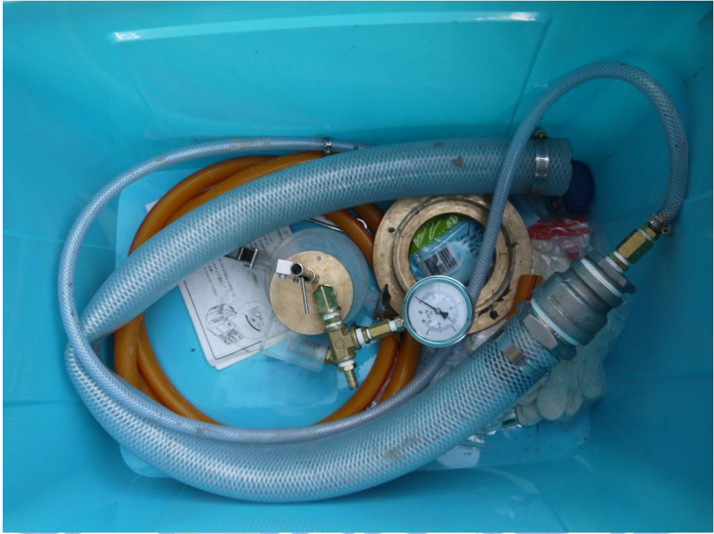
圖 4-2 現地小型射流沖蝕試驗儀 Mini Jet 系統
