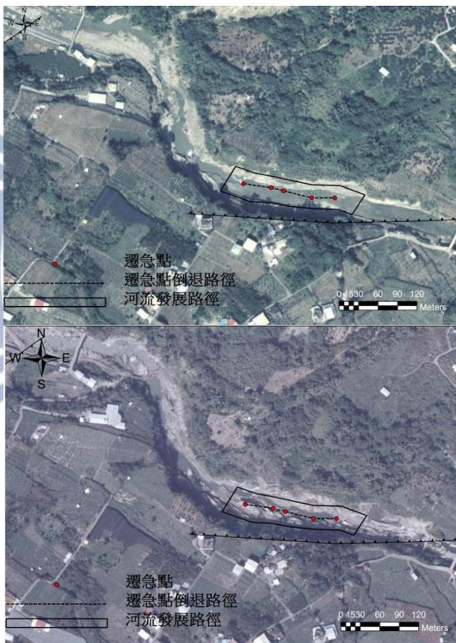
圖 4-20 沙連溪遷急點倒退河段
