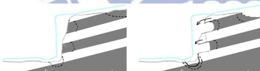
圖 4-35 軟硬材料互層岩層排列為順向低傾角的狀況
