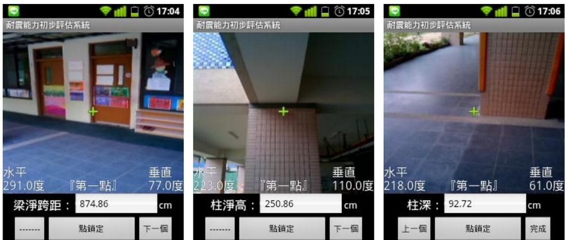
圖4. 61 案例實作-輔助計算長度量測
